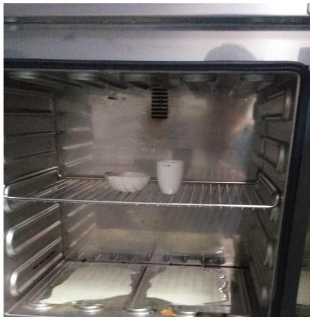
*Figura 9. Colocación en horno a 50°C por 30 minutos.*
