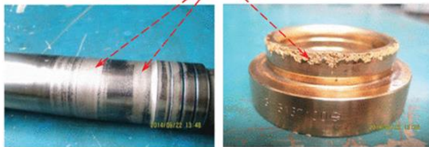
Figura 9. Efecto del desgaste por erosión debido a la cavitación en el pistón de impacto y en la bocina.
