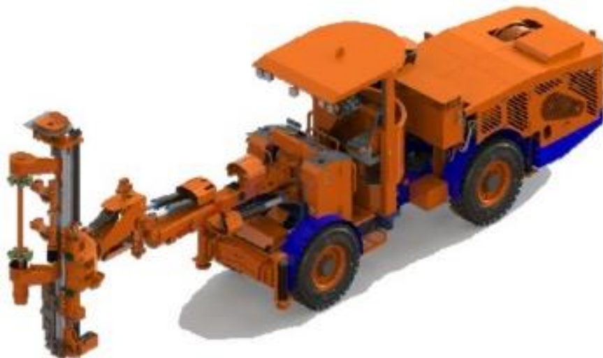
Figura 23. Equipo Electrohidráulico mediano. Fuente: Elaboración propia.
