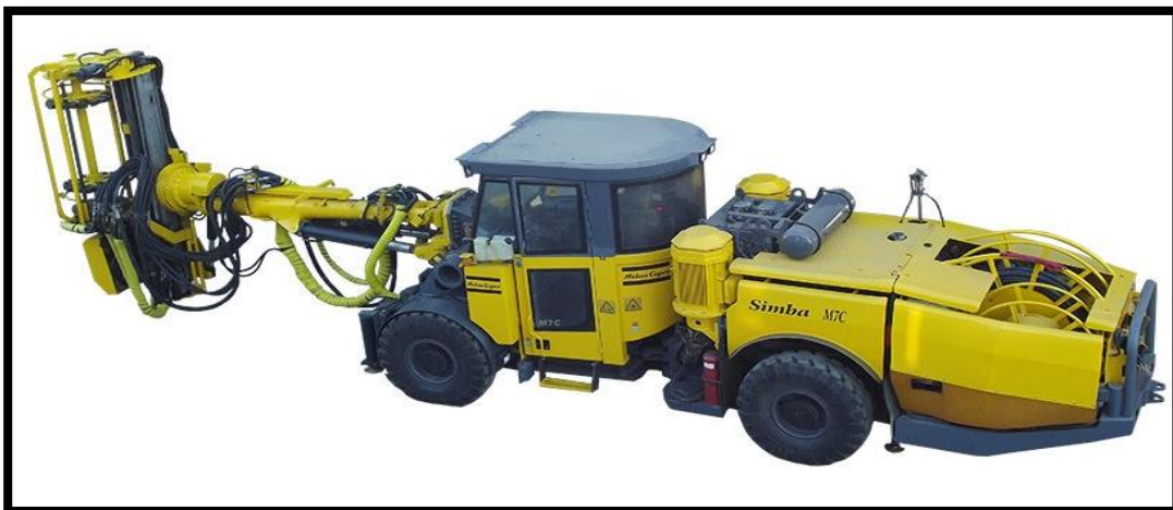
Figura 1. Equipo de perforación de taladros largos para secciones mínimas de 4.00m x 4.00m. Fuente: EPIROC,2016.
