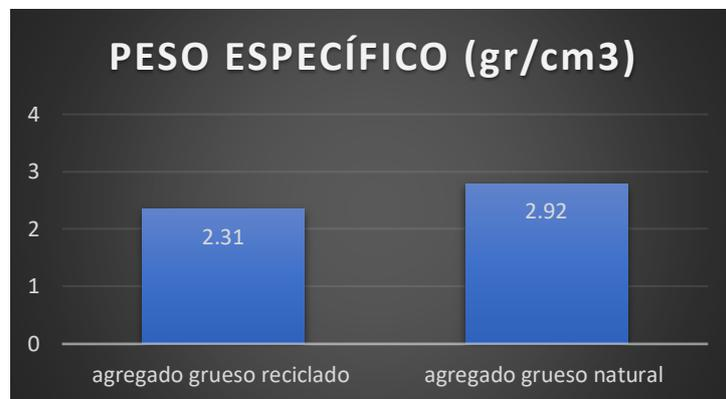
**Figura 6.** Peso específico
