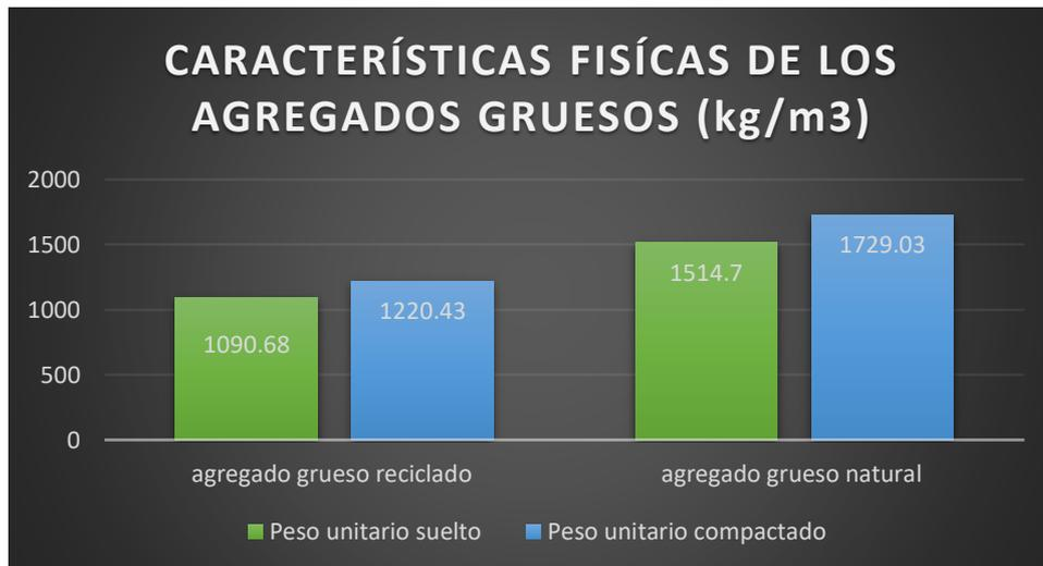
**Figura 7.** Peso unitario suelto y compactado
