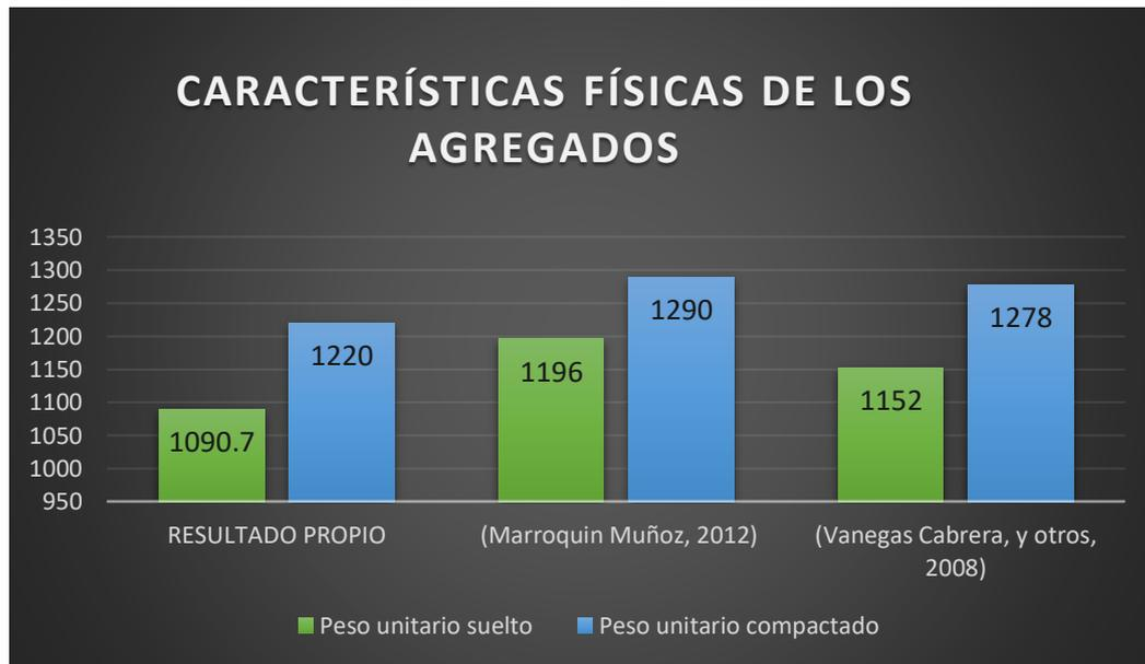
**Figura 17.** Comparación de Peso Volumétrico
