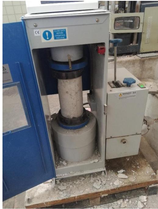
**Anexo 4. Análisis del comportamiento mecánico del concreto  $f'c$  210 kg/cm<sup>2</sup> con agregados reciclados de demolición, San Juan de Lurigancho 2018**
