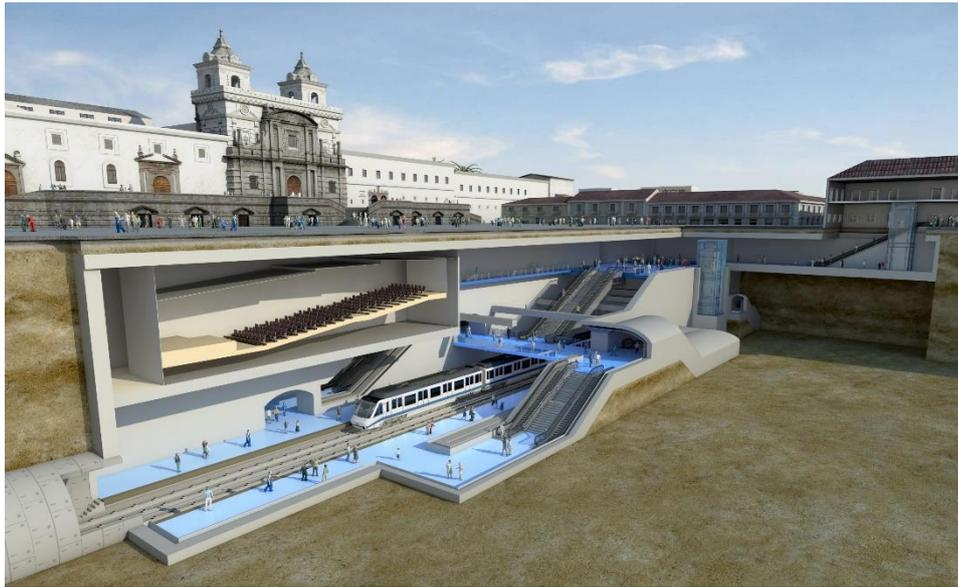
*Figura 46.* Vista sección 3D de estación de San Francisco Intercambiador Av. 24 de Mayo.
