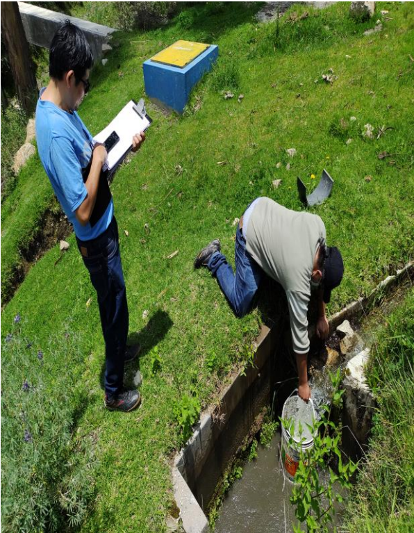
Aforo de la captación
