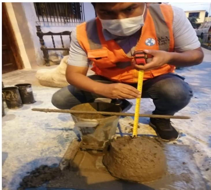
Figura 13 slump 5" de concreto tradicional
