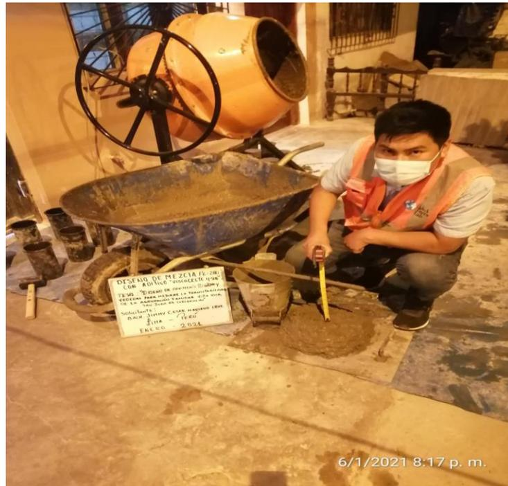
Figura 14 slump 8 1/2" de concreto con aditivo viscocrete 4500
