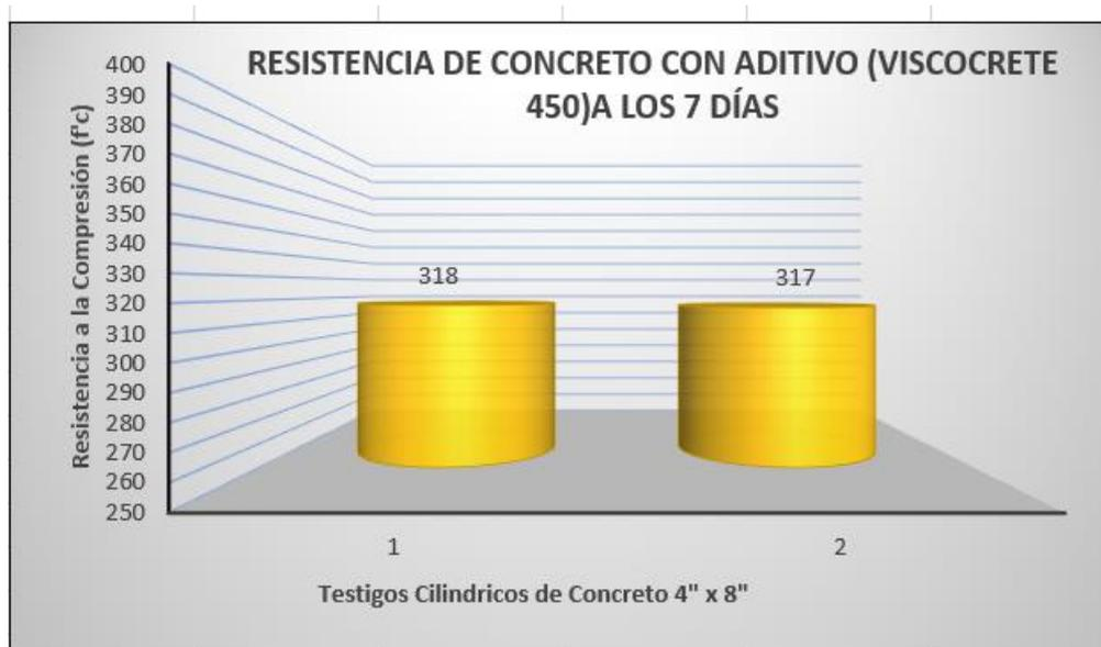
Figura 17 Resistencia de concreto con aditivo a los 7 días
