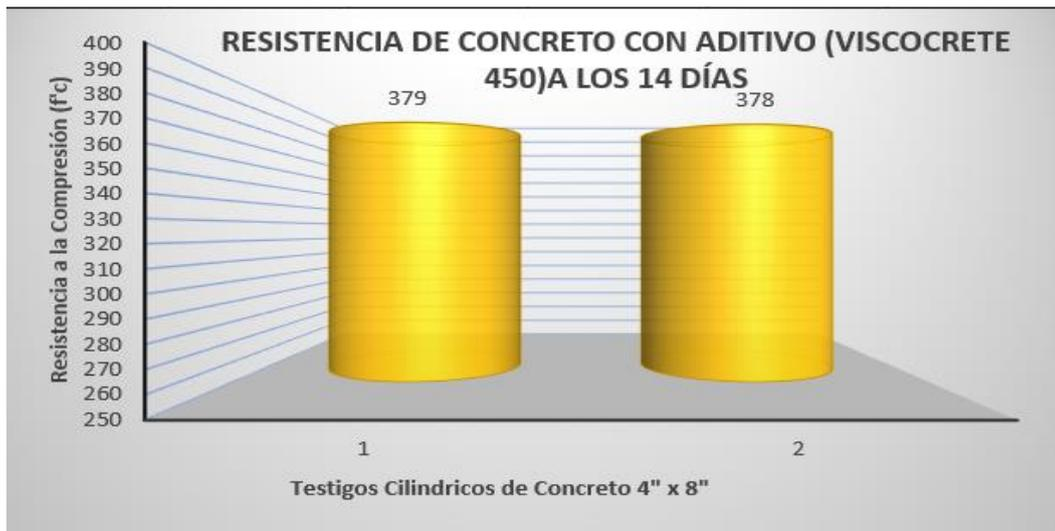
Figura 18 Resistencia de concreto con aditivo a los 14 días
