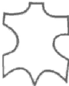
Con un recubrimiento: Producto cuya capa de recubrimiento no supere un tercio del espesor total del producto, pero excede los 0,15 mm
