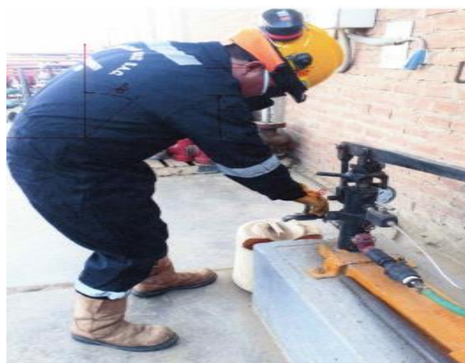
Ilustración 31. Abrir llave de la bomba hidráulica BAKER.
