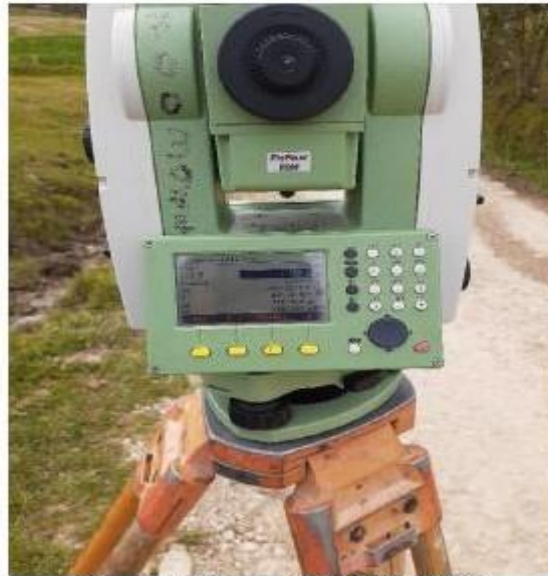
Figura N° 06: Estación DT 06 LEYCA
