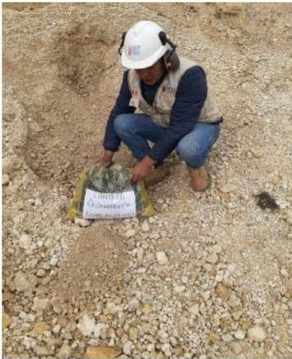
Figura 3: Excavación para muestra de calicata
