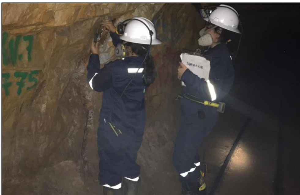
Medición del buzamiento en la caja techo
