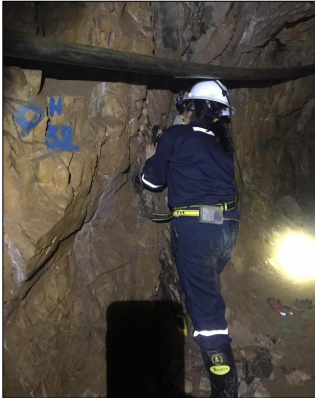
Medición de la dirección de buzamiento en la caja piso
