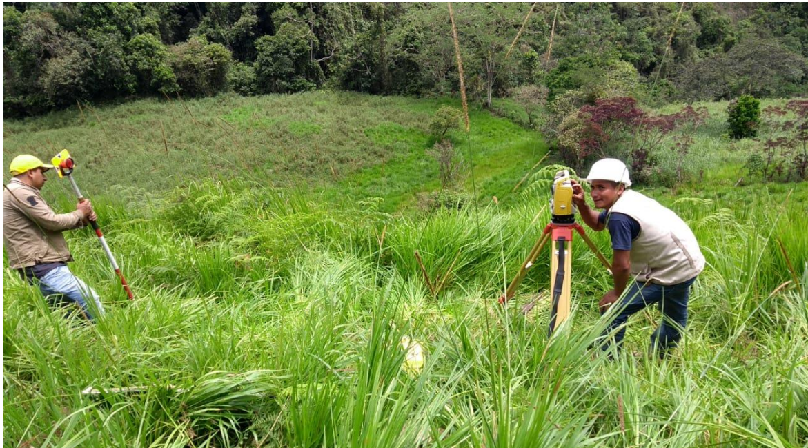
Foto N° 2: Levantamiento topográfico por el método de poligonal abierto con dos puntos conocidos
