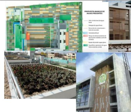
Utilización de materiales amables con el medio ambiente, acabados de bajo mantenimiento, bajo consumo energético, tratamiento primario de recolección de basuras, temperatura confort sin equipos mecánicos, iluminación inteligente, aislamientos térmicos naturales, tratamiento de aguas grises, tratamiento de vientos y paisajismo.
