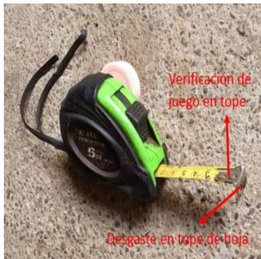
Figura 10: huincha en mal estado
