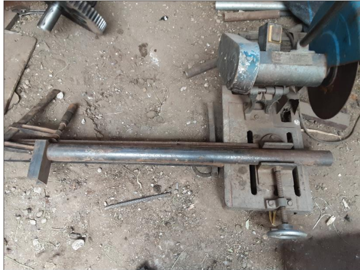
Figura 11: Máquina cortadora de metales mal acondicionada para cortar tubería
