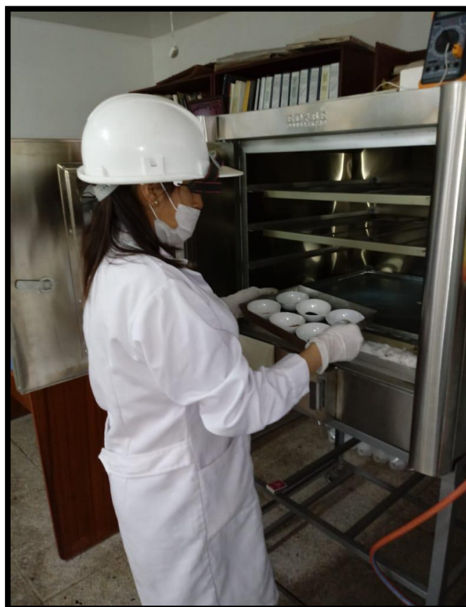
Figura 12. Colocando las muestras en el horno.
