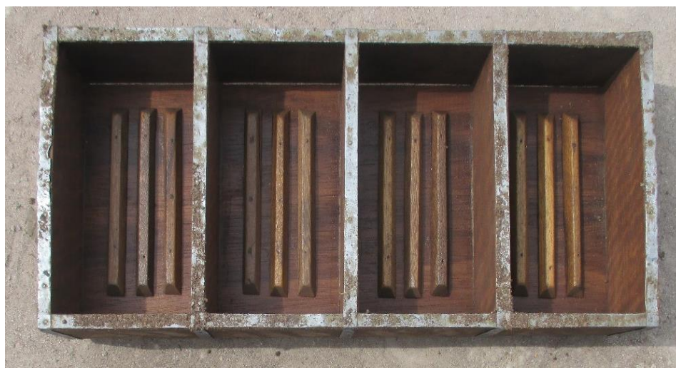
Figura 5. Molde (gavera) utilizado en el labrado. Fotografía propia.
