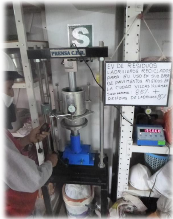
Fotografía 25. Ensayo de CBR para la muestra M4.
