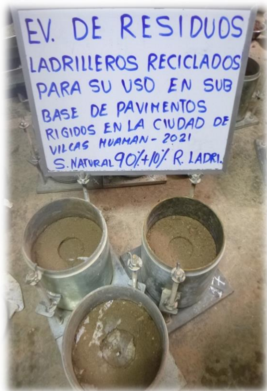
Fotografía 24. Ensayo de CBR para la muestra M3.
