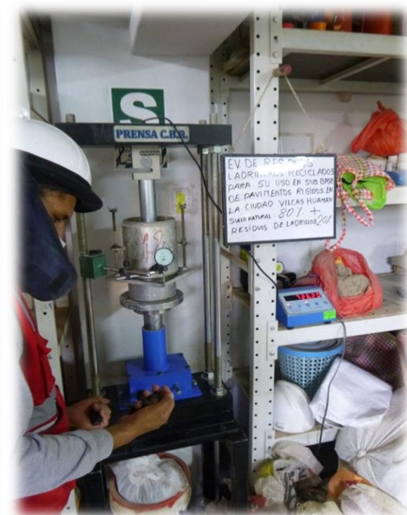
Fotografía 26. Ensayo de CBR para la muestra M5.
