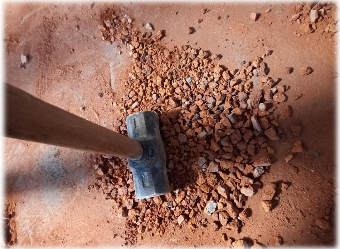
Fotografía 04. Triturado manual de residuos ladrilleros.
