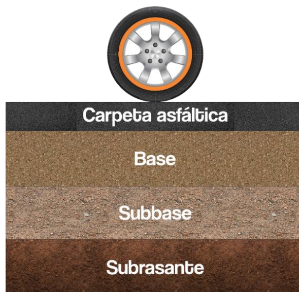
Figura 12. Configuración estructural típica de un pavimento flexible. Elaboración propia.
