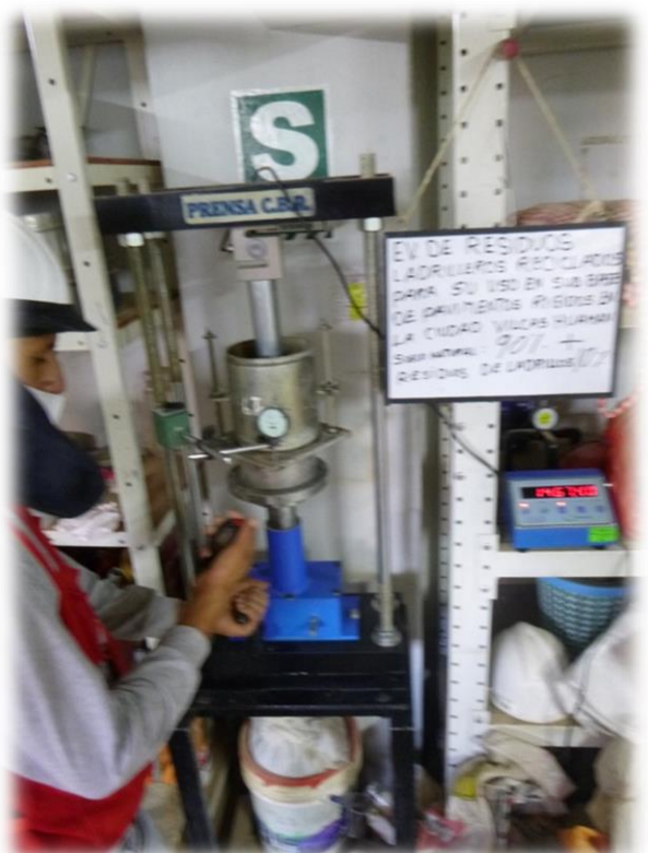
Fotografía 24. Ensayo de CBR para la muestra M3.
