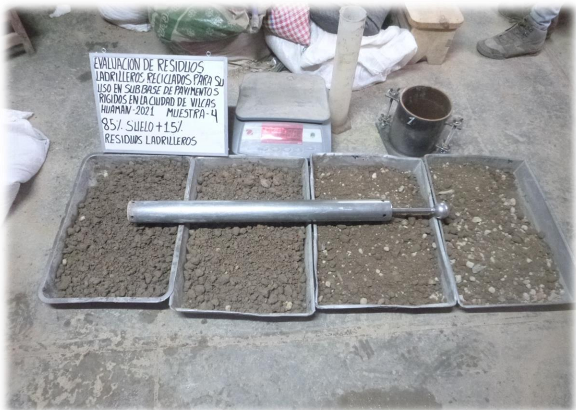
Fotografía 20. Ensayo de próctor modificado para la muestra M4.
