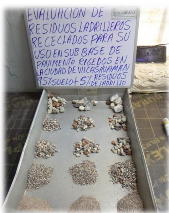
Fotografía 12. Análisis granulométrico por tamizado para la muestra M2 y M3.
