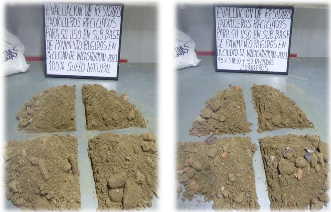
Fotografía 09. Muestra representativa por cuarteo para la mezcla M1y M2.
