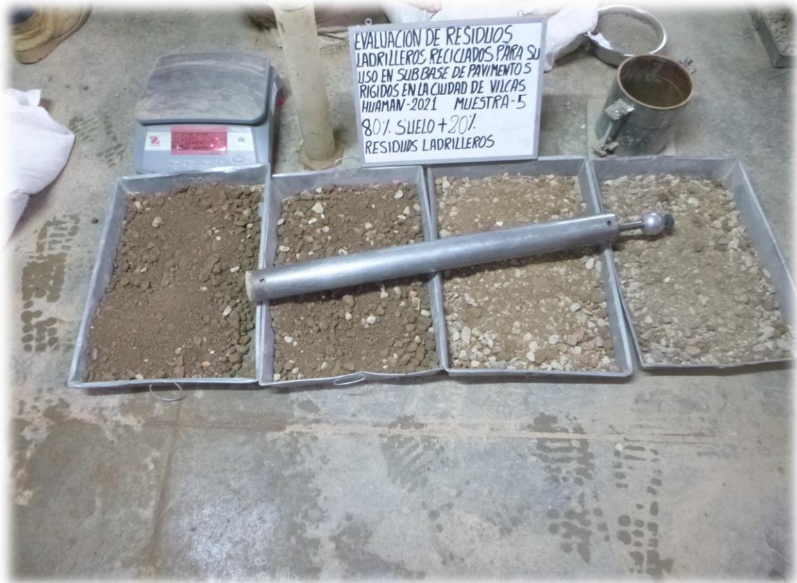
Fotografía 21. Ensayo de próctor modificado para la muestra M5.
