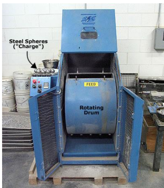
Figura 42. Máquina de Los Ángeles. Adaptado de Pavement Tools Consortium, s. f.
