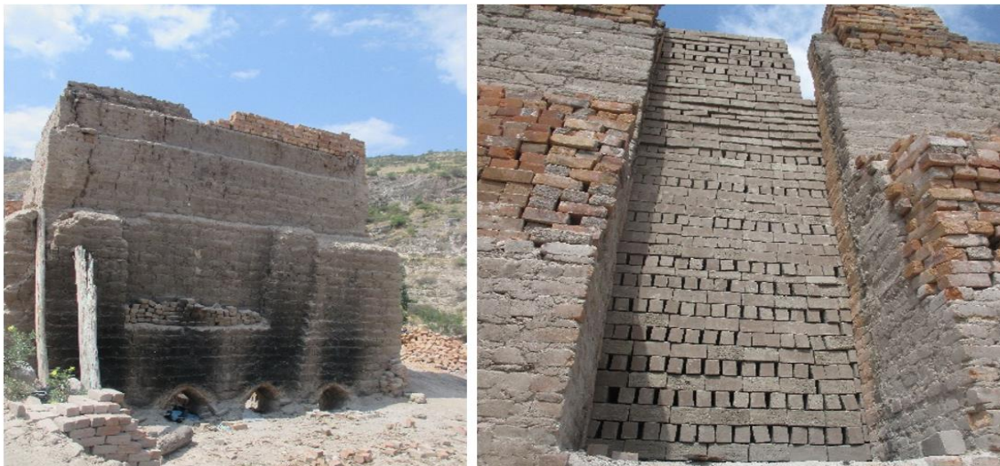
Figura 8. Horno artesanal lleno de ladrillos crudos. Fotografía propia.
