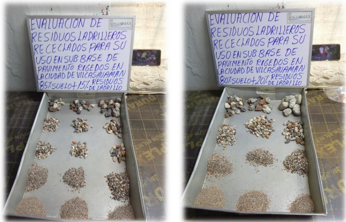
Fotografía 13. Análisis granulométrico por tamizado para la muestra M4 y M5.
