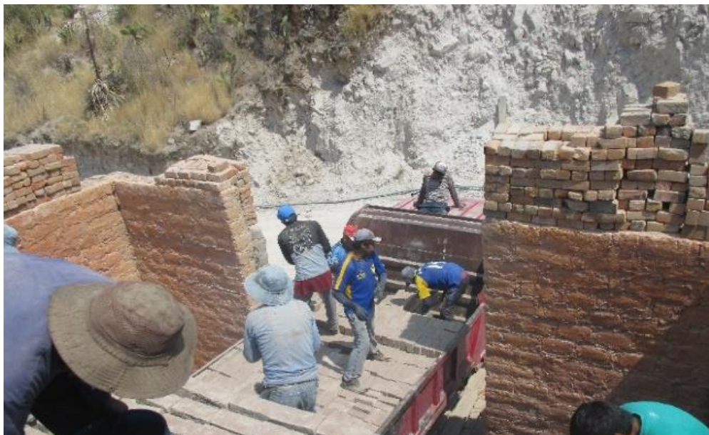
Figura 7. Proceso de acomodo de ladrillos crudos. Fotografía propia.
