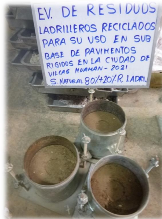
Fotografía 26. Ensayo de CBR para la muestra M5.
