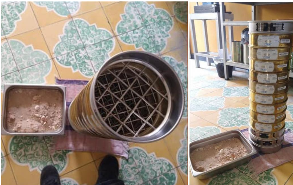
Figura 17. Ensayo de granulometría por tamizado. Adaptado de Laboratorio de Materiales, Suelos y Concreto (LAMSYC, [s.f.]
