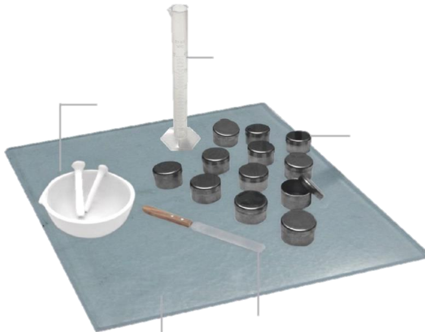
Figura 38. Equipos para realizar el ensayo del límite plástico. Adaptado de Pinzuar (s. f.).
