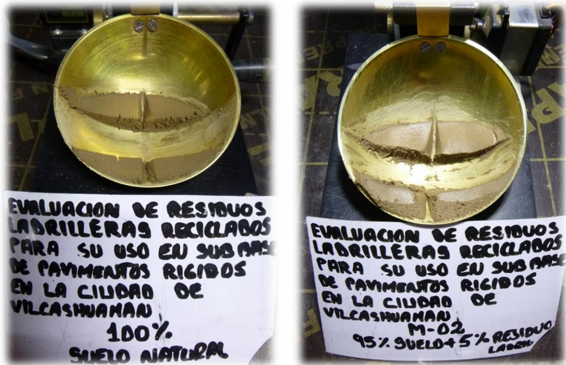
Fotografía 14. Ensayo de límite plástico líquido para la muestra M1 y M2 mediante la cuchara de Casagrande.
