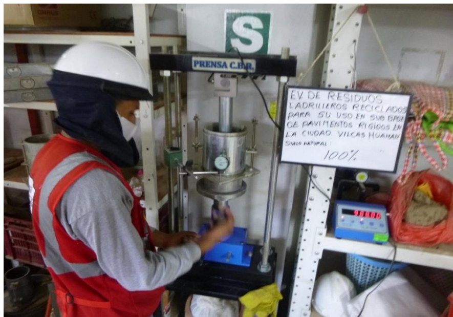
Figura 74. Ensayo de CBR para la muestra M1. Fotografía propia.
