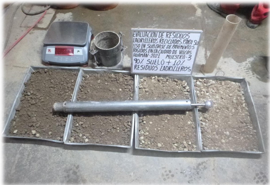
Fotografía 19. Ensayo de próctor modificado para la muestra M3.
