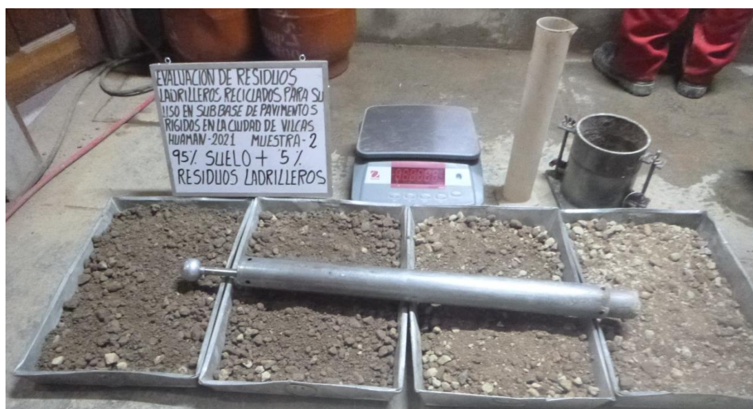
Figura 65. Muestras preparadas para el ensayo de próctor de la mezcla M2. Fotografía propia.
