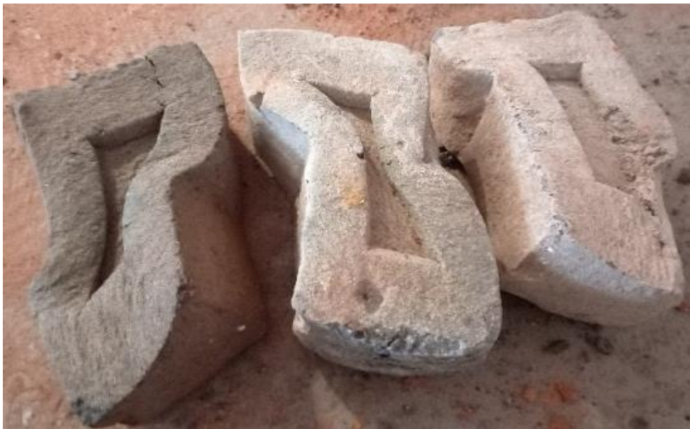
Figura 11. Ladrillos con exceso de cocción (recochos). Fotografía propia.
