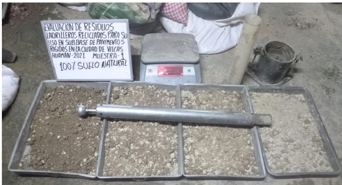
Figura 64. Muestras preparadas para el ensayo de próctor de la mezcla M1. Fotografía propia.
