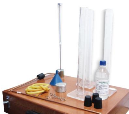
Figura 39. Equipos para realizar el ensayo de relación de equivalente de arena. Adaptado de Pinzuar (s. f.).
