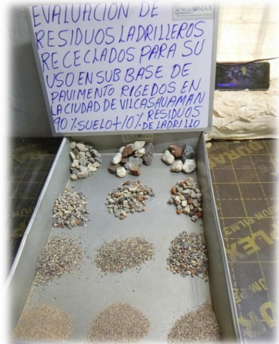
Fotografía 12. Análisis granulométrico por tamizado para la muestra M2 y M3.
