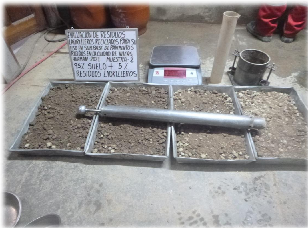
Fotografía 18. Ensayo de próctor modificado para la muestra M2.
