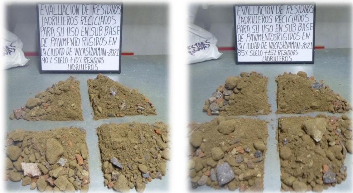
Fotografía 10. Muestra representativa por cuarteo para la mezcla M3 y M4.
