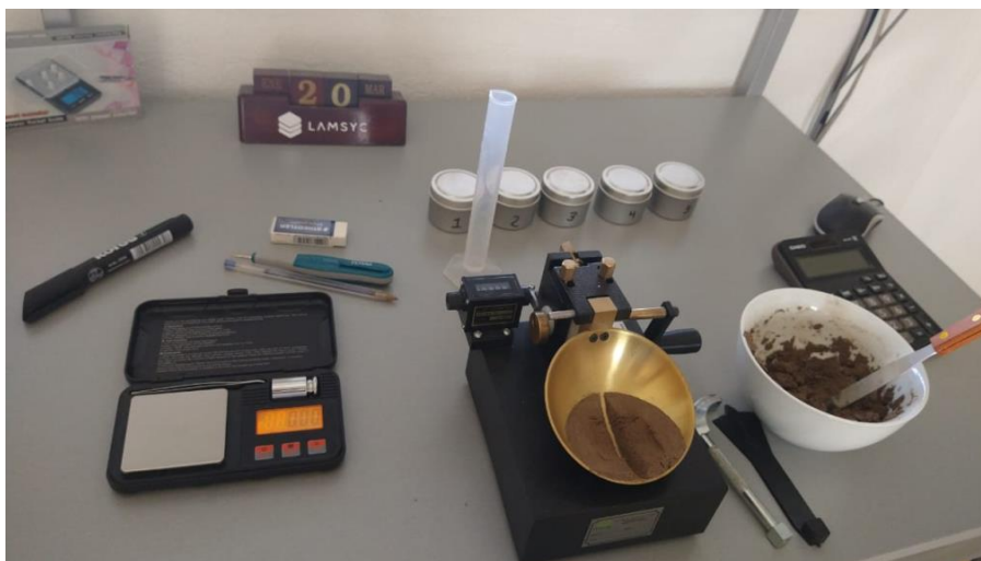
Figura 37. Equipos para el ensayo del límite líquido. Adaptado de LAMSYC (s. f.).
