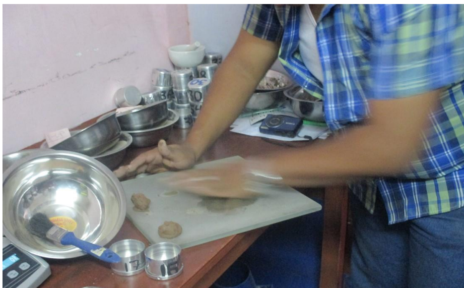
Figura 47. Formación de cilindros de la masa de suelo. Fotografía propia.
