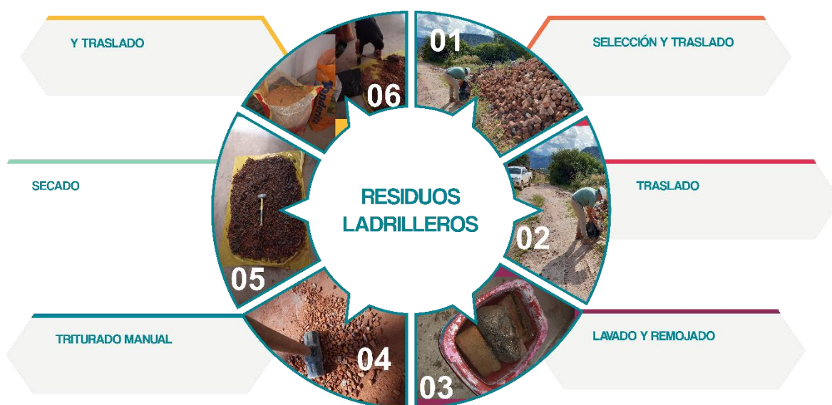
Figura 36. Flujograma del proceso de obtención de residuos ladrilleros triturados. Elaboración propia.
