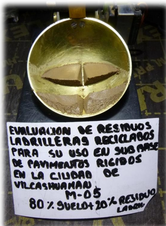
Fotografía 16. Ensayo de límite líquido para la muestra M5 mediante la cuchara de Casagrande.
