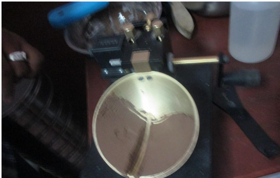
Figura 46. Muestra colocada en la cazuela de Casagrande. Fotografía propia.
