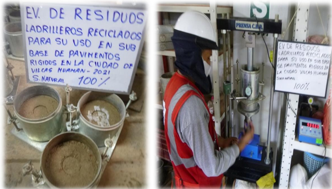
Fotografía 22. Ensayo de CBR para la muestra M1.
