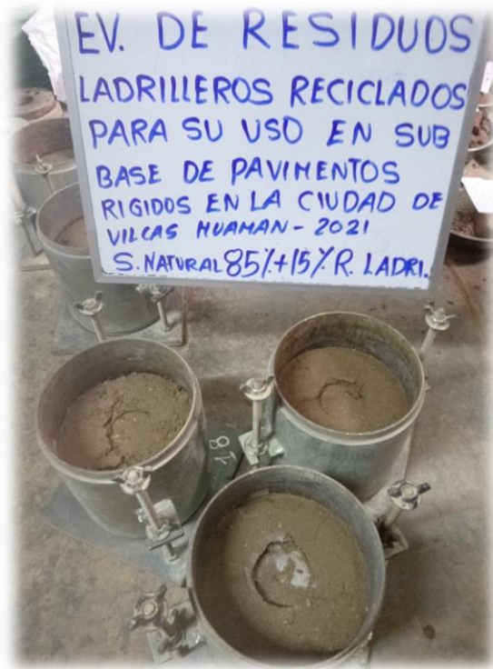
Fotografía 25. Ensayo de CBR para la muestra M4.
