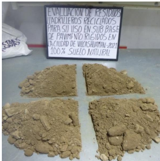
Figura 57. Cuarteo de la muestra M1. Fotografía propia.
