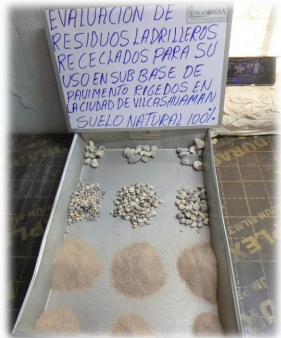
Fotografía 11. Análisis granulométrico por tamizado para la muestra M1.
