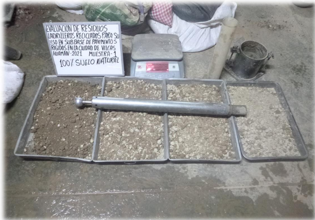
Fotografía 17. Ensayo de próctor modificado para la muestra M1.
