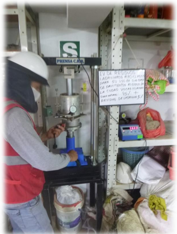
Fotografía 23. Ensayo de CBR para la muestra M2.
