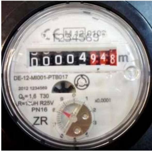
Figura 5: Medidor de chorro múltiple
