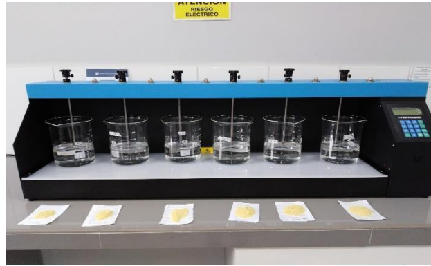
Figura 14. Utilización la prueba de jarras para empezar el tratamiento
