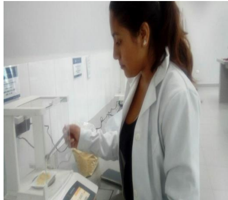
Figura 13. Pesado (2, 4 y 6 gr) de la cascara del Lupinus mutabilis en la balanza analítica
