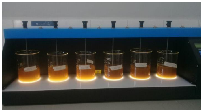
Figura 15. Prueba de jarras realizando con 120 revoluciones por minuto
