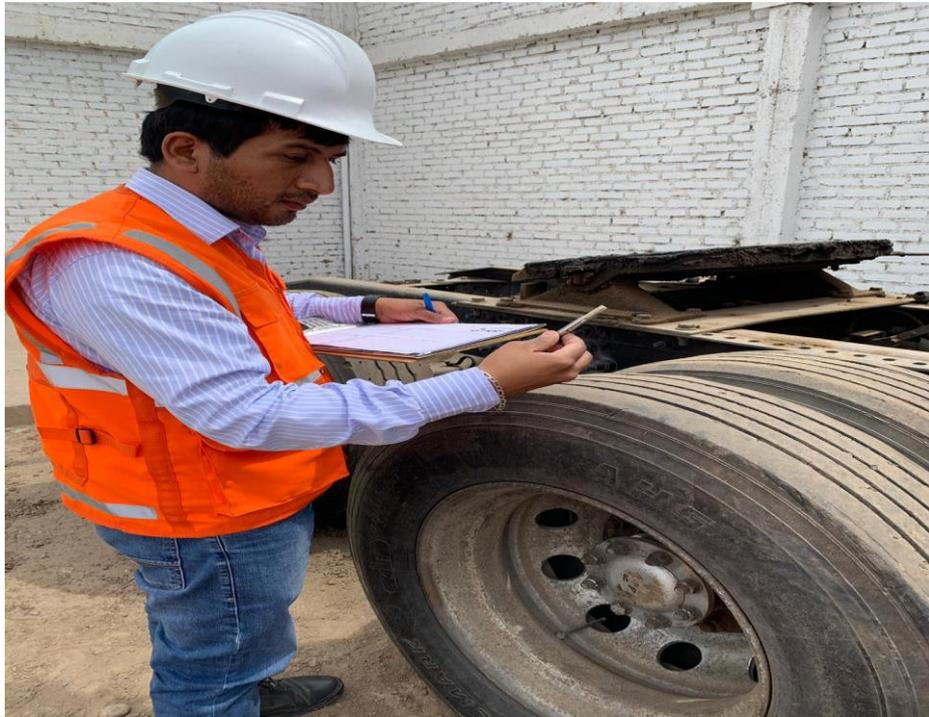
*Figura 12. Inspección de los neumáticos 11R22.5*
