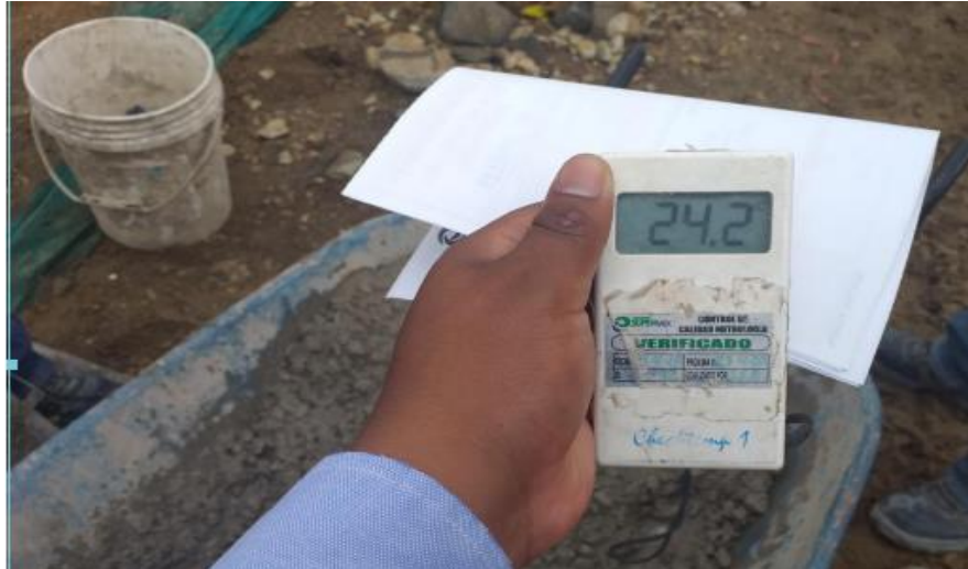
Figura 50. Determinación de la Temperatura del concreto Fuente: Elaboración Propia
