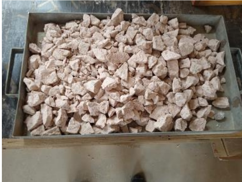
Figura 39. Muestra de Sillar para Ensayo de Peso específico Varillado Fuente: Elaboración Propia
