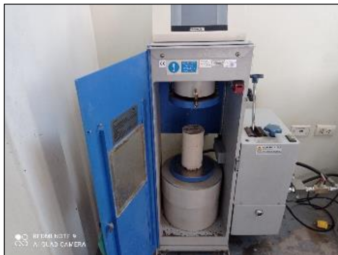
Figura 60. Prensa Hidráulica para Ensayo de Resistencia a la Compresión Fuente: Laboratorio "San Pablo"
