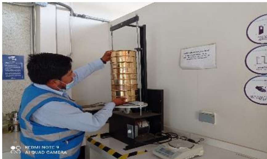
Figura 43. Proceso de Agitación de Tamices Fuente: Elaboración Propia
