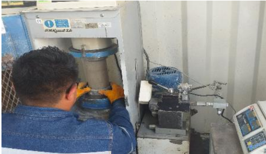
Figura 33. Ensayo de Resistencia a la Compresión Fuente: Laboratorio de Concretos Supermix
