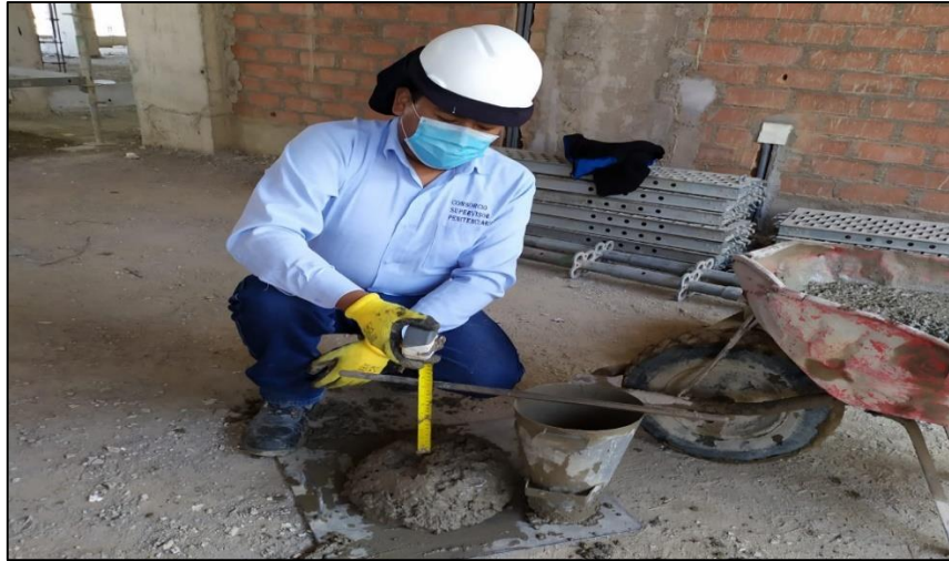
Figura 48. Determinación del Asentamiento del Concreto Fresco Fuente: Elaboración Propia
