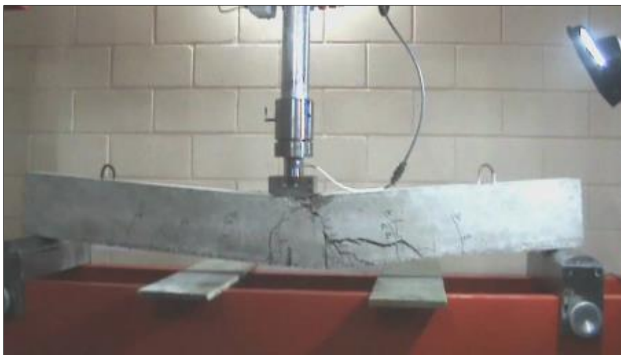
Figura 34. Ensayo cuando la carga se aplica al punto medio Fuente: Producción Propia
