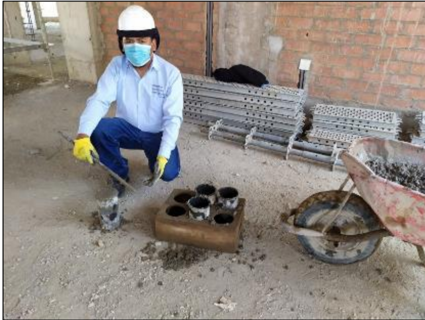
Figura 45. Elaboración de Probetas Cilíndricas de concreto Fuente: Elaboración Propia
