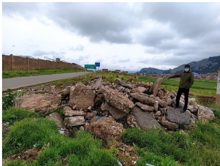
Figura 14. Obtención de los residuos de pavimento rígido
