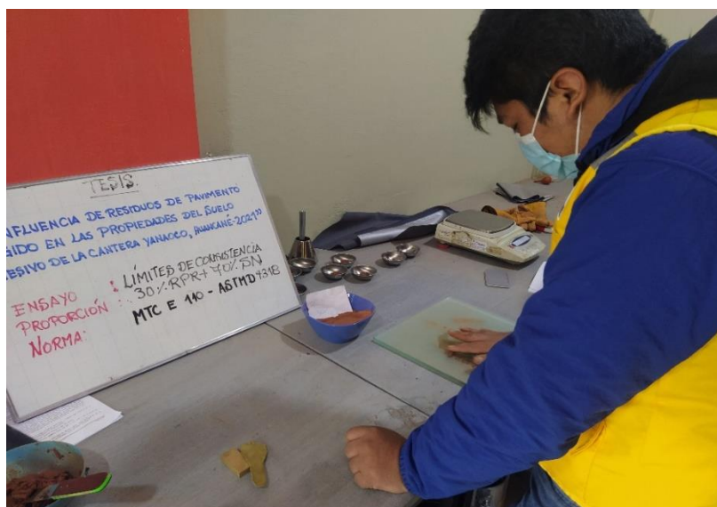
Figura 21. Proceso de realizado de rollitos antes de su fractura para el ensayo de límite plástico
