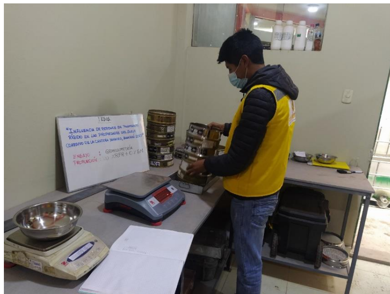
Figura 18. Granulometría por tamizado (fracción gruesa) agitándolos energicamente
