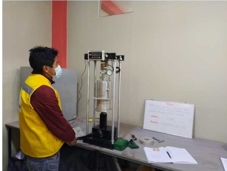
Figura 25. Penetración de los moldes de 12, 25 y 56 golpes en la prensa de CBR
