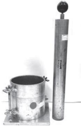
Figura 7. Equipo de compactación en laboratorio, por Camacho-Tauta, Moliu Gómez y Reyes Ortiz, 2014, p. 188
