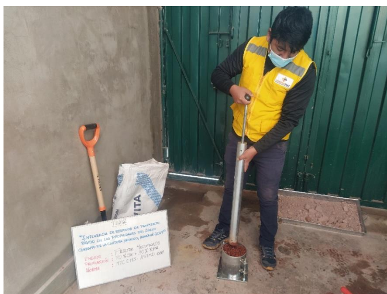
Figura 23. Compactado de la última capa con una energía de compactación de 2700 kN-m/m 3
