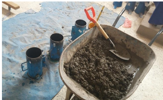
FOTOGRAFÍA N° 9: Mezcla de áridos granulares con el cemento
