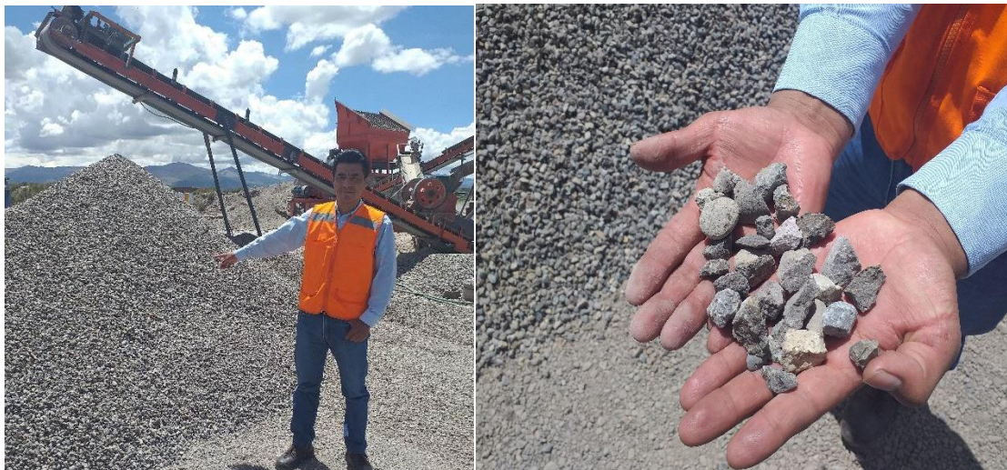
FOTOGRAFÍA N° 6: Proceso de trituración del concreto reciclado
