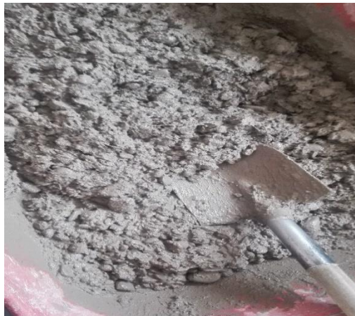
FOTOGRAFÍA N° 12: Mezclado manual del % de concreto reciclado con un % de cemento
