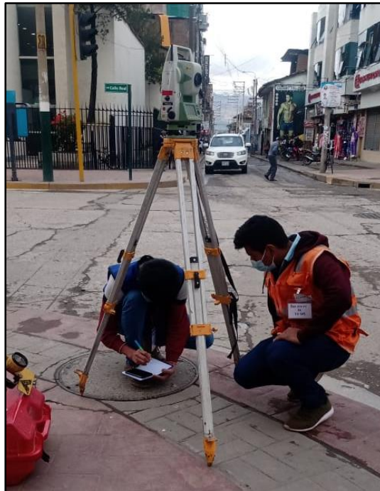
Fotografía 6: Tomando coordenadas de la estación 1.
