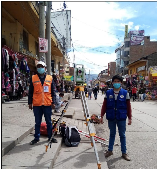
Fotografía 10: Levantamiento topográfico finalizado en el tramo 3 del Jirón Cajamarca.
