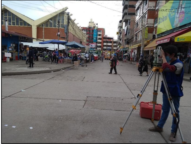
Fotografía 9: Realizando el levantamiento topográfico en el tramo 3 del Jirón Cajamarca.
