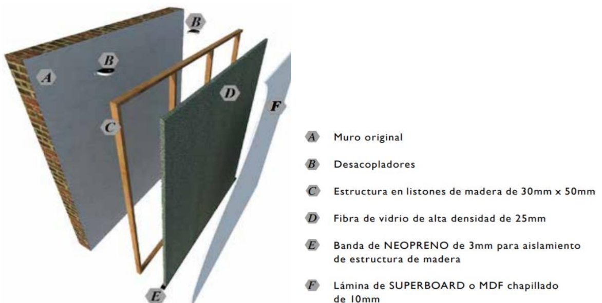
Figura 2: Esquema de paredes aisladas
