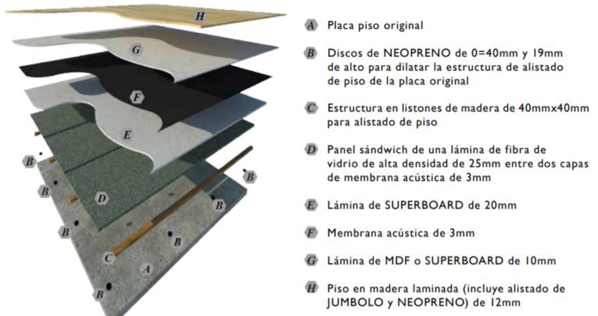
Figura 1: Esquema de aislamiento de pisos.
