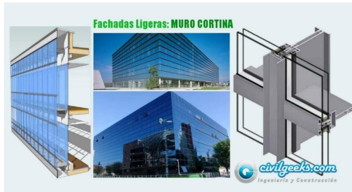
Figura 72: Muro Cortina. Fuente: Civilgeeks.
