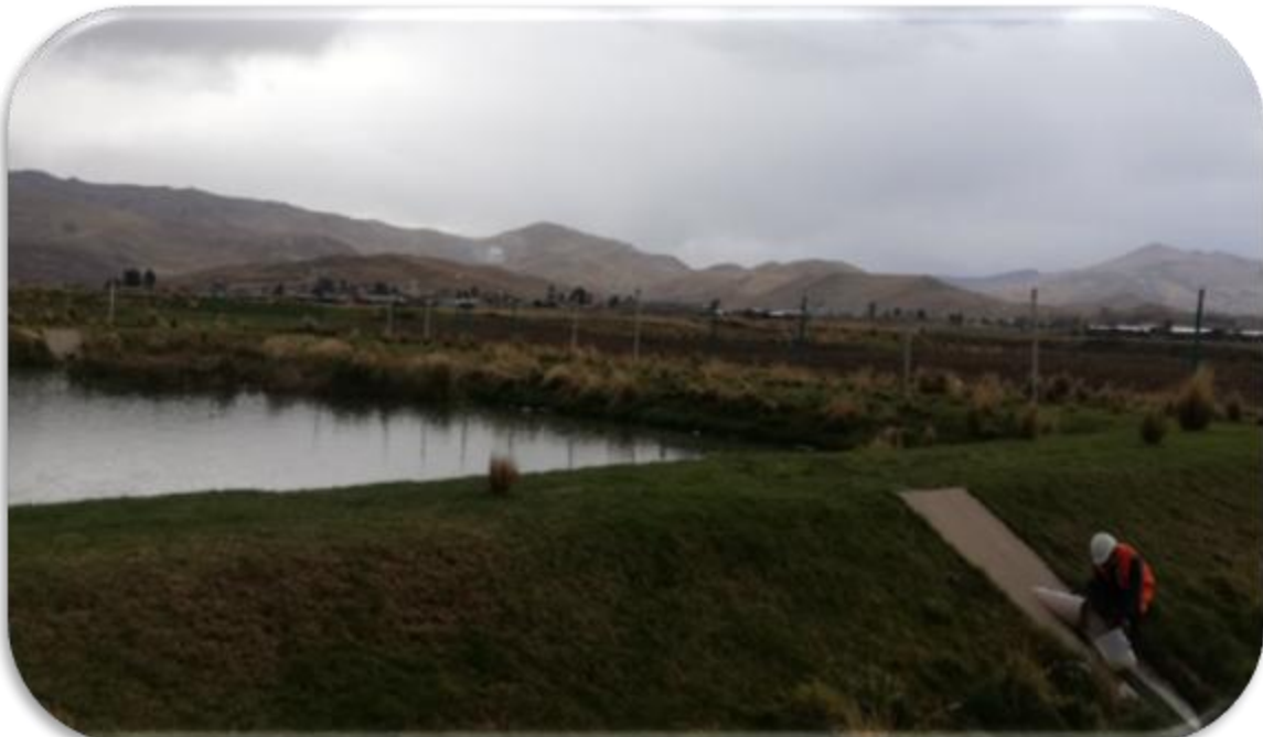
FOTOGRAFÍA 04: Aforo de caudal por el método volumétrico en el afluente laguna facultativa 2
