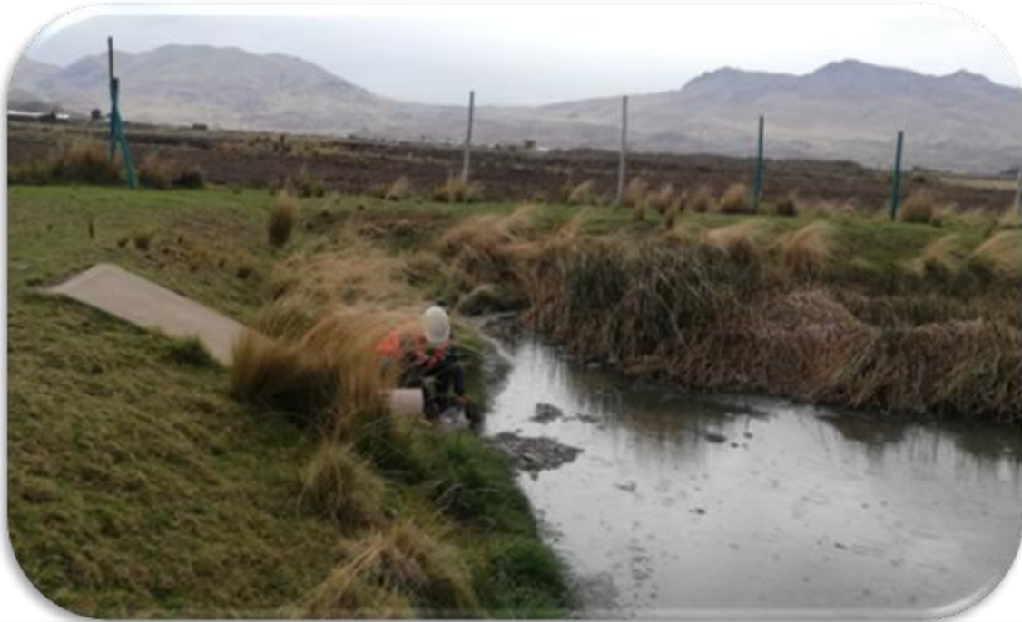
FOTOGRAFÍA 03: Aforo de caudal por el método volumétrico en el afluente laguna facultativa 1
