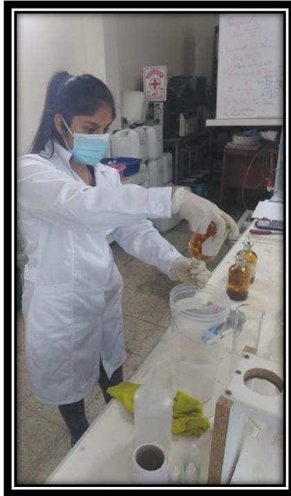
Figura 48. Reacción del tercer reactivo para el parámetro OD
