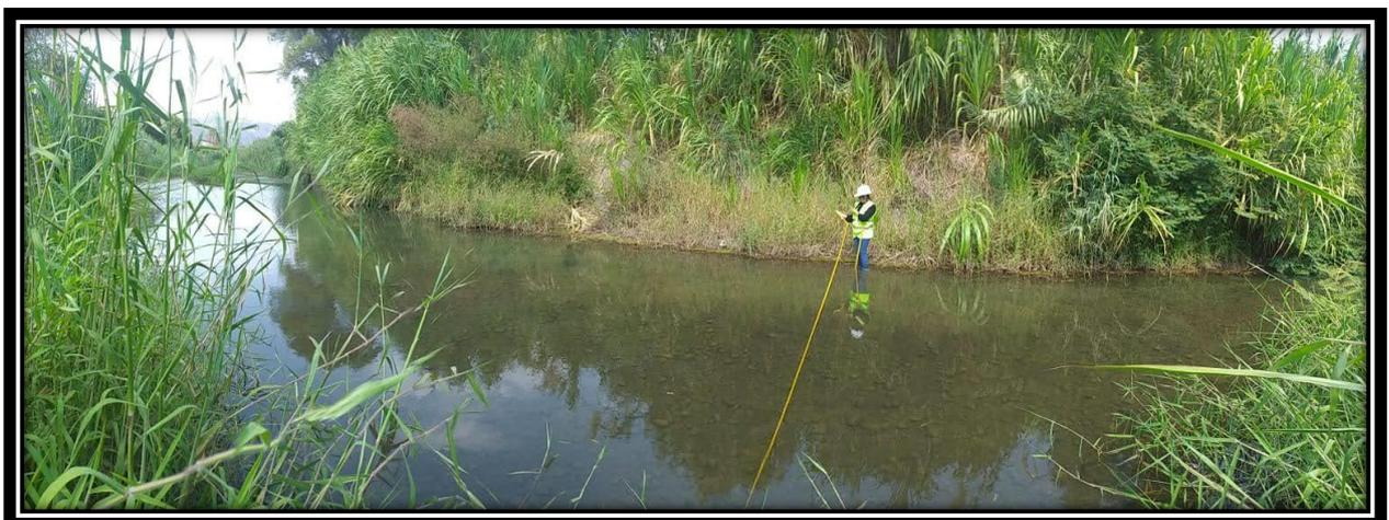
Figura 17. Medición del ancho del río Huarmey
