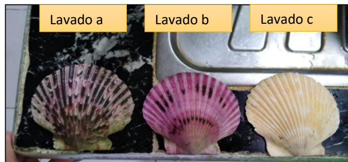
Figura 8: Tipos de lavado de las valvas de concha de abanico: a) Lavado con hidróxido de sodio, b) Lavado con agua desmineralizada y c) Lavado con agua común
