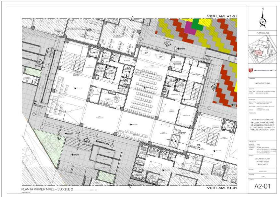
Figura 99. Planta de distribución primer nivel – bloque 2.
