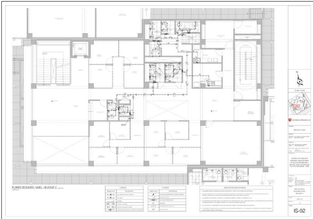
Figura 171. Planta segundo nivel de red de agua – bloque 2.
