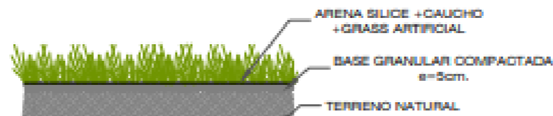
DETALLE DE GRASS SINTÉTICO ESCALA: 1/10
