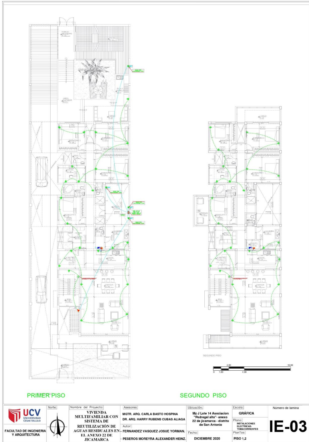
Instalaciones de tomacorriente
