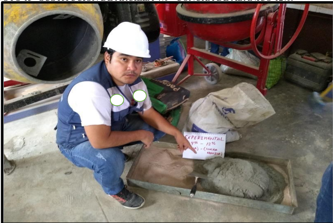
FOTO 15- SUSTITUCION DE ARCILLA 4% - CONCHA DE ABANICO 12%.
