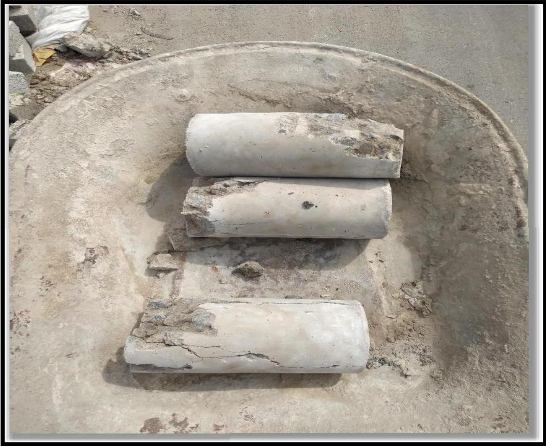
FOTO 21—RESULTADO DEL ENSAYO DE COMPRESION 4% - 12%; 6% - 18%.
