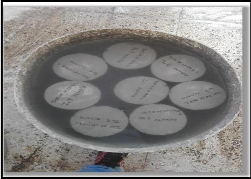
FOTO 19- CURADO DE PROBETAS.
