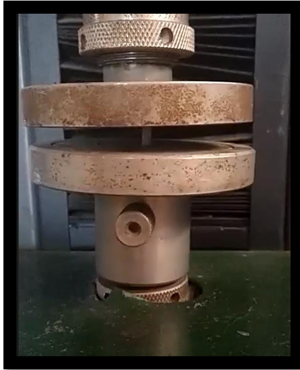
Figura 13: Ensayo de resistencia compresiva en la Máquina Universal CMT – 5L marca LG.
