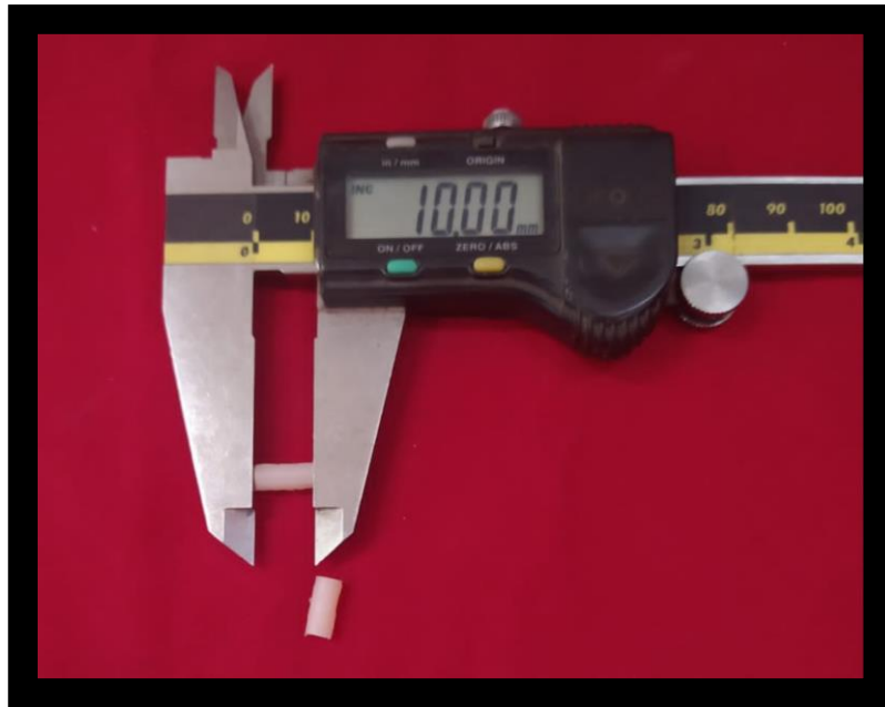
Figura 11: Medición de la altura del cilindro de resina con Calibrador Vernier.
