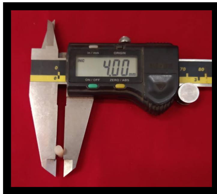
Figura 12: Medición del diámetro del cilindro de resina con Calibrador Vernier.
