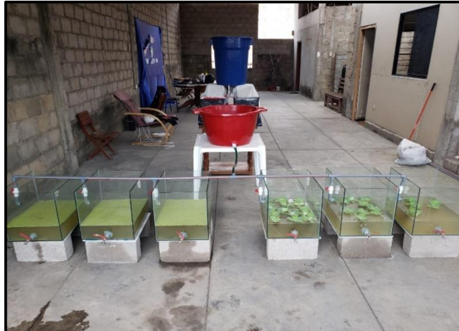
Figura 19: Sistema de biofiltro completo en funcionamiento. Fuente: Elaborado por los autores.
