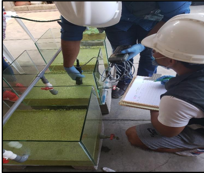
Figura 23: Análisis de parámetros en el sistema de la macrófita Lemna minor .
