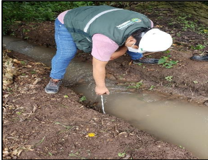
Figura 5: Medición de la profundidad. Fuente: Elaborado por los autores.
