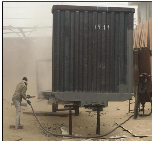
Calidad de acabado de estructuras metálicas con 6.3 bar.
