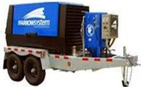
Figura 1: Máquina de chorro de aire comprimido con arena Fuente: (Zuta, 2018)
