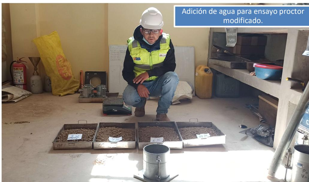
Adición de agua para ensayo proctor modificado.
