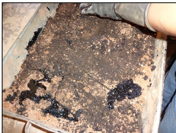
Figura 21. Muestra M-01 mezclado con aceite residual
