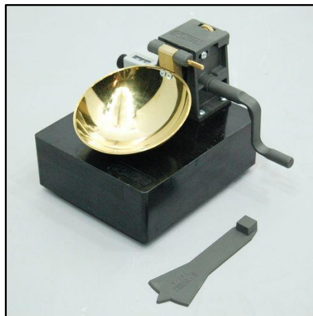
Figura 07: Prueba de límite líquido
