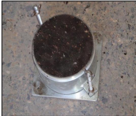
Figura 22. Muestra M-01 compactado incorporando aceite residual.
