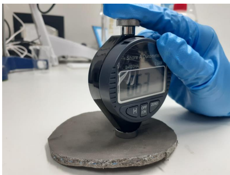
Figura 8. Ensayo de dureza de la malla de fibra de vidrio.
