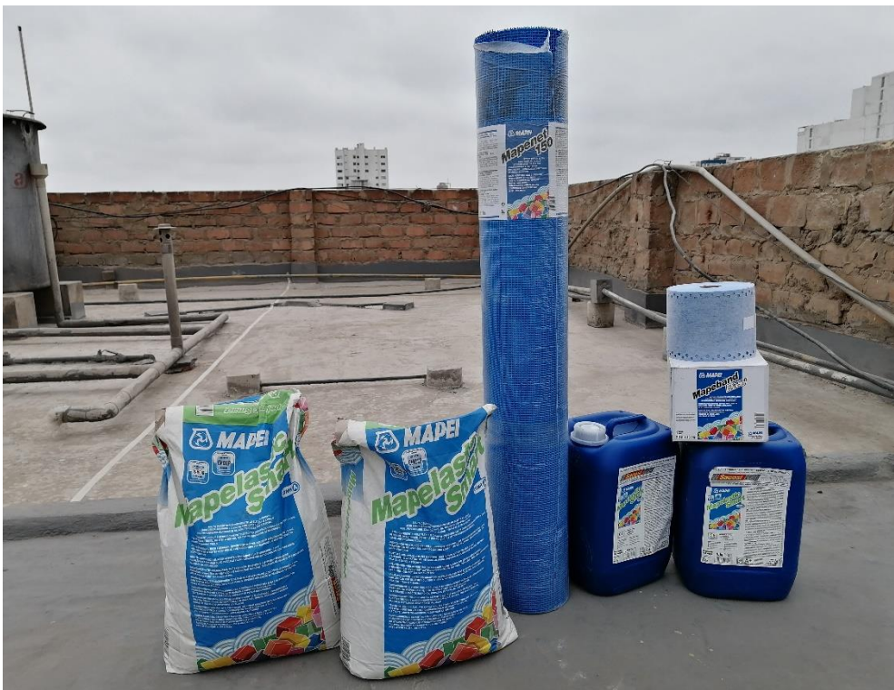
Foto N° 14: Vista de los materiales a usar en conjunto con la malla de fibra de vidrio Mapenet 150, los cuales son el mapelastik Smart Pack y el rollo mapeband Easy.
