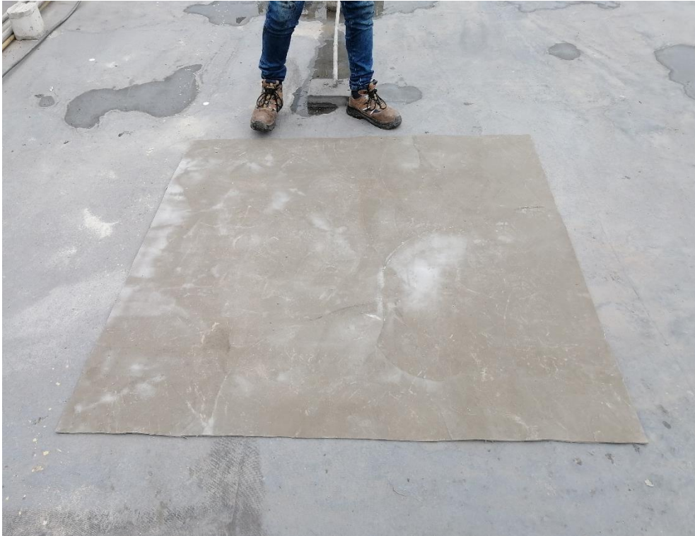
Foto N° 47: Vista final de la muestra extraída de la malla de fibra de vidrio con el mortero cementoso.
