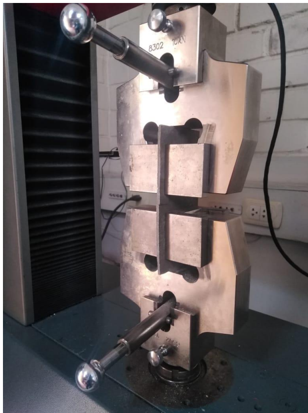
Figura 10. Ensayo de rasgado de la malla de fibra de vidrio.
