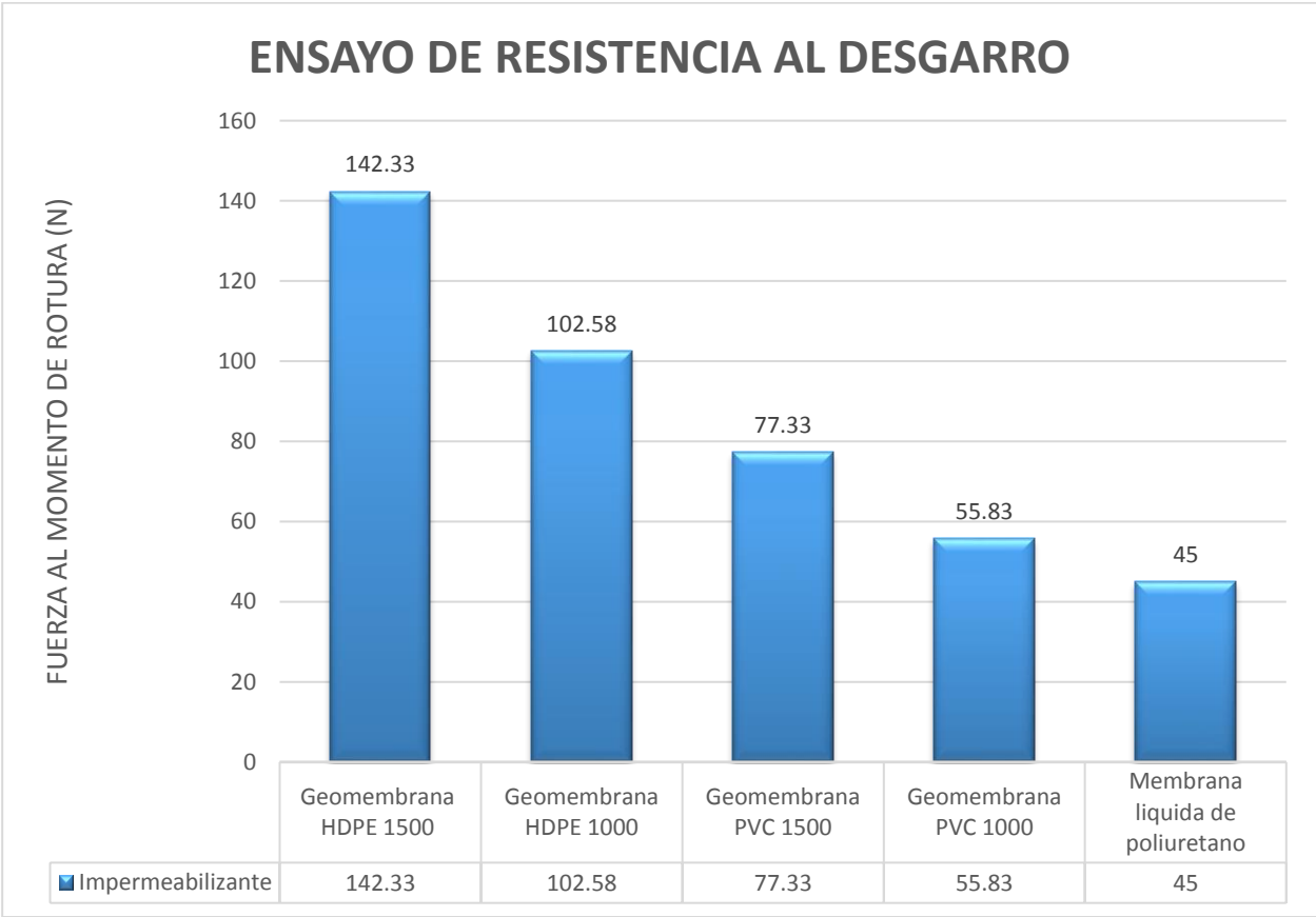
Grafico 10. Grafica comparativa de resultados del ensayo de resistencia al desgarro a excepción de la malla de fibra de vidrio.
