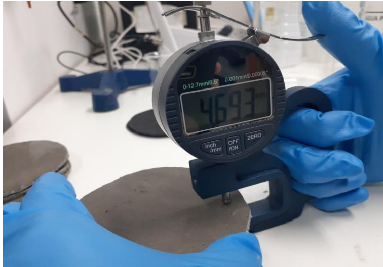
Figura 6. Ensayo de medida de espesor de la malla de fibra de vidrio.
