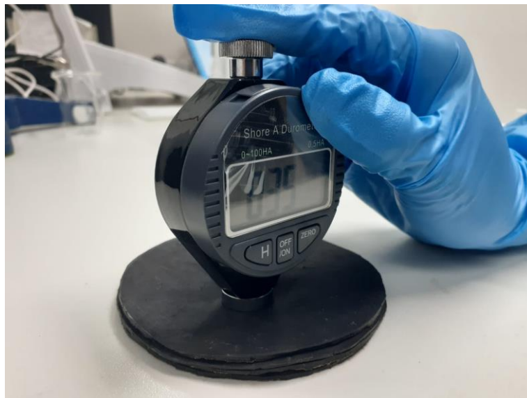
Figura 7. Ensayo de dureza de la membrana líquida de poliuretano.
