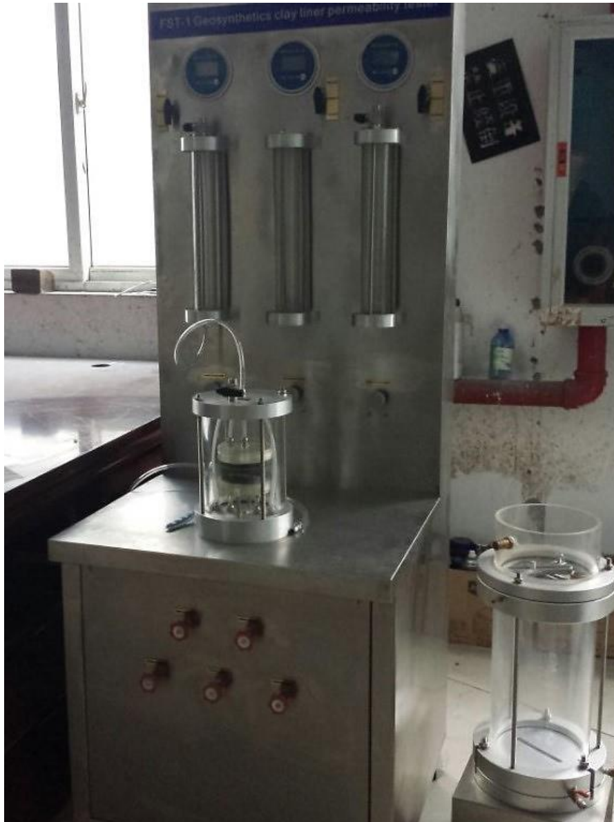
Figura 11. Equipo donde se realizaron los ensayos de permeabilidad.
