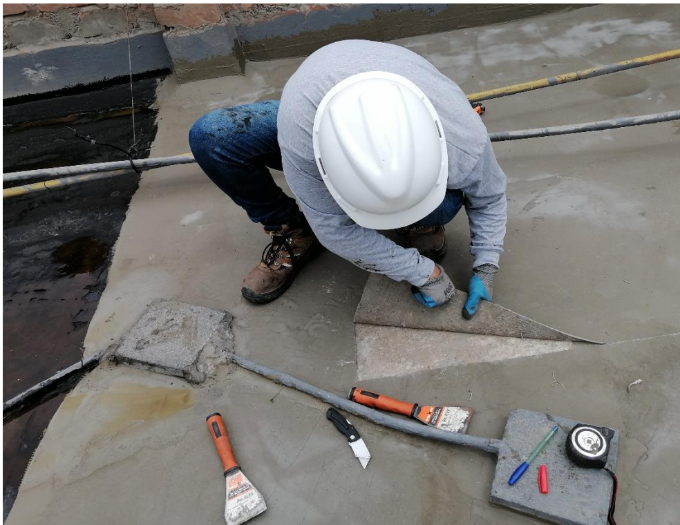
Foto N° 46: Se inició con el retiro de la muestra con mucho cuidado de no rasgarlo y poder tener una buena muestra con ayuda de espátulas.
