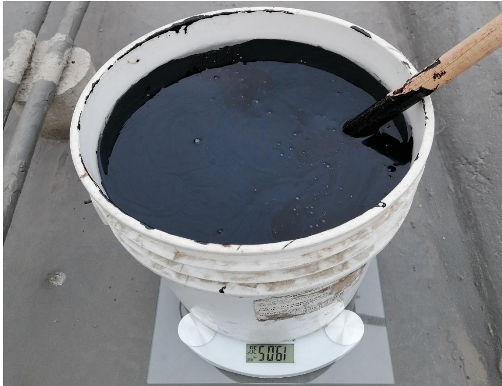
Foto N° 17: En el recipiente se lograron mezclar los componentes A y B y se tomó las medidas del peso de la mezcla despreciando el peso del balde.
