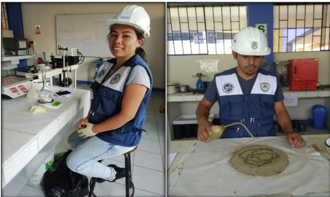
*Figura 16: Tarando el picnómetro para ensayar los agregados*
