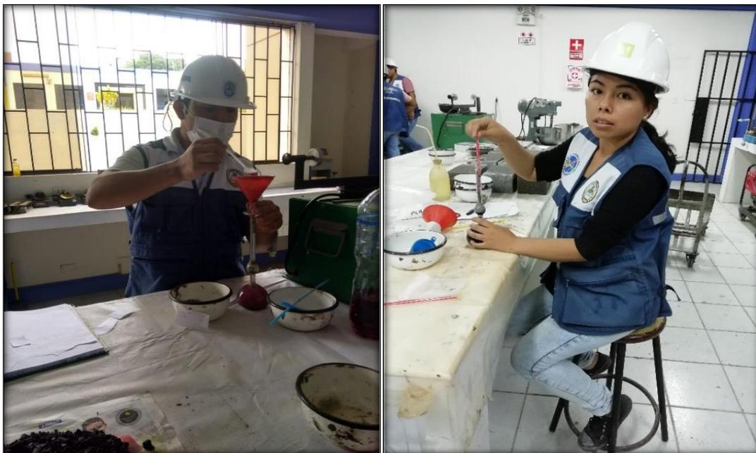
**Figura 12:** Peso específico de los materiales a sustituir y las combinaciones.
