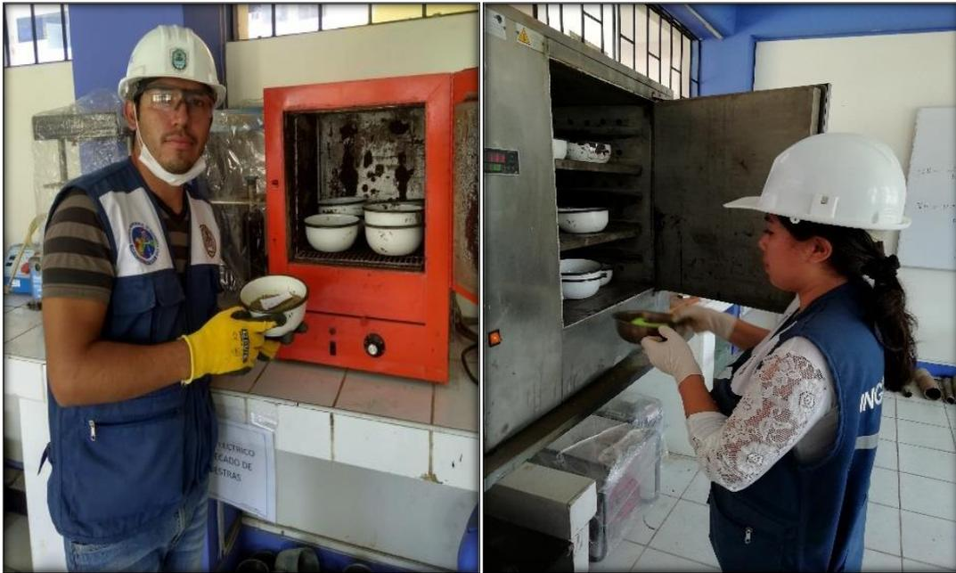
**Figura 17:** Colocando los agregados en el horno para determinar el contenido de humedad
