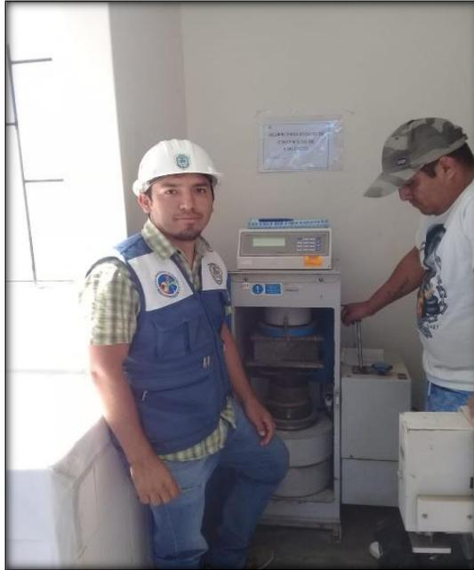
**Figura 24:** Ensayo de Resistencia a la Compresión de los ladrillos de concreto con el técnico del laboratorio de Suelos
