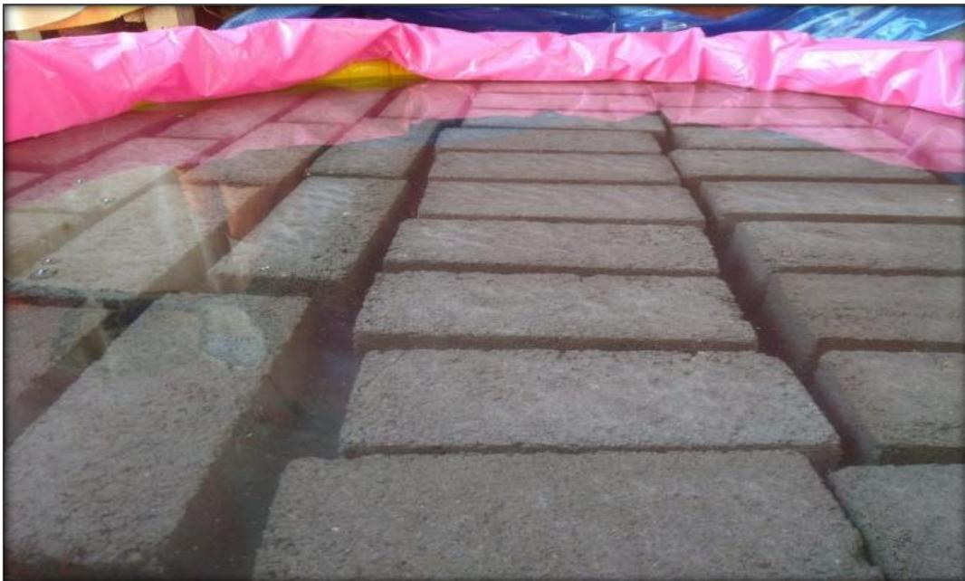
*Figura 23: Curado de los ladrillos sumergidos en el agua.*
