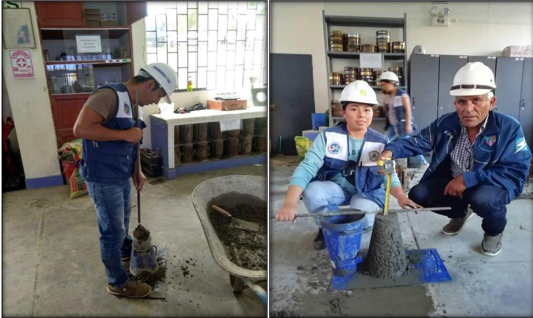
**Figura 19:** Apisonando el concreto en tres capas con una varilla de acero
