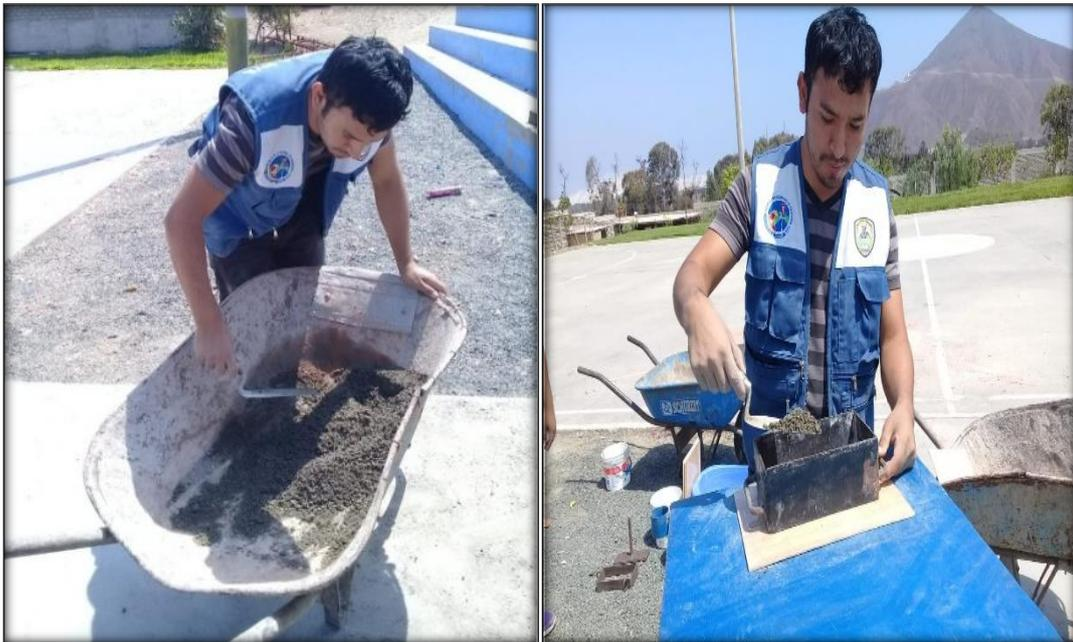
**Figura 21:** Elaboración de la mezcla de concreto y llenado en el molde para luego ser vibrado en la mesa vibradora.
