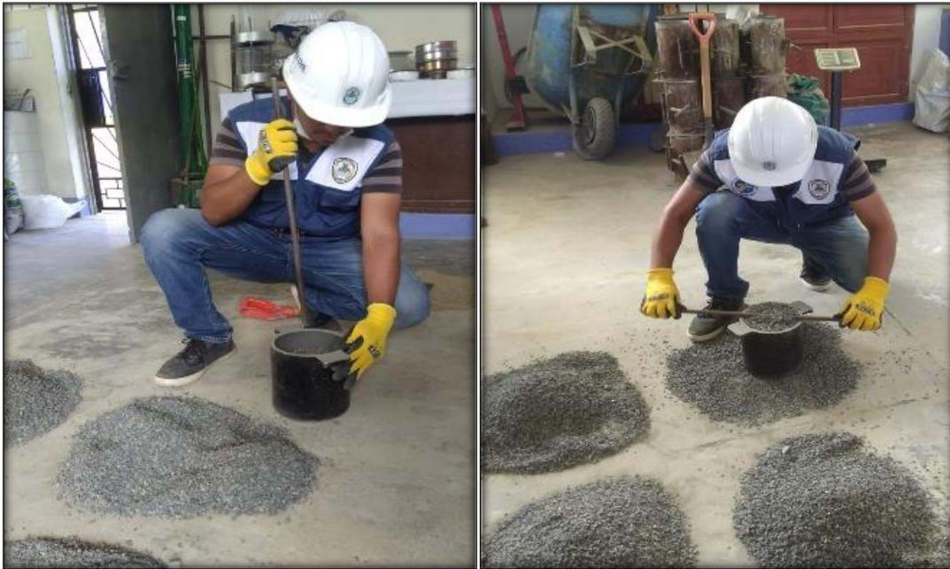
*Figura 15: Chuceo y enrasado del agregado con una varilla de acero.*
