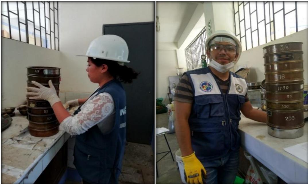
*Figura 14: Tamizado del Agregado Grueso y fino. (Arena Gruesa y Confitillo)*
