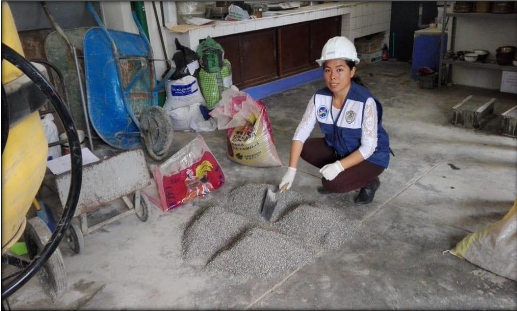
*Figura 13: Cuarteo de los agregados*
