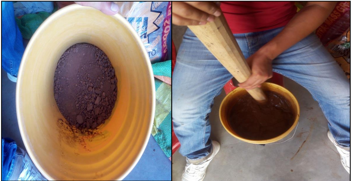
FOTO N°40, N°41: Se seleccionó la arcilla y se procedió al lavado de la misma haciendo uso de un balde de 21Lt. Se hecho arcilla en el balde hasta la 1/8 parte del balde para ser disuelta con agua.
