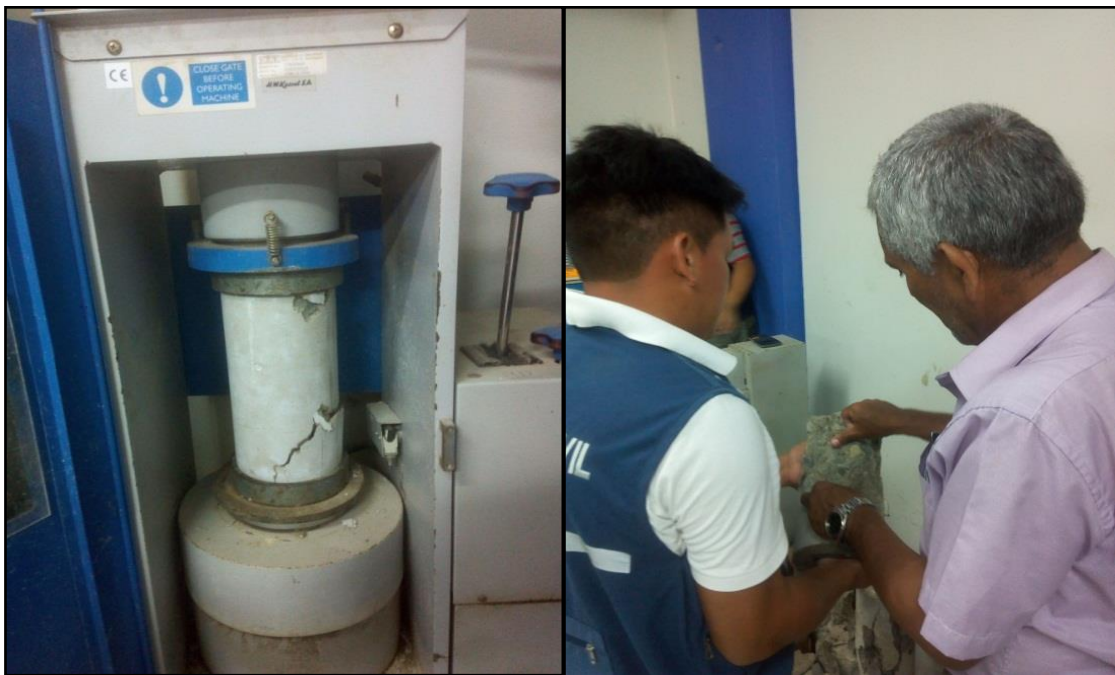
FOTO N°89, N°90: Ensayo a la compresión de probetas experimentales al 16%.
