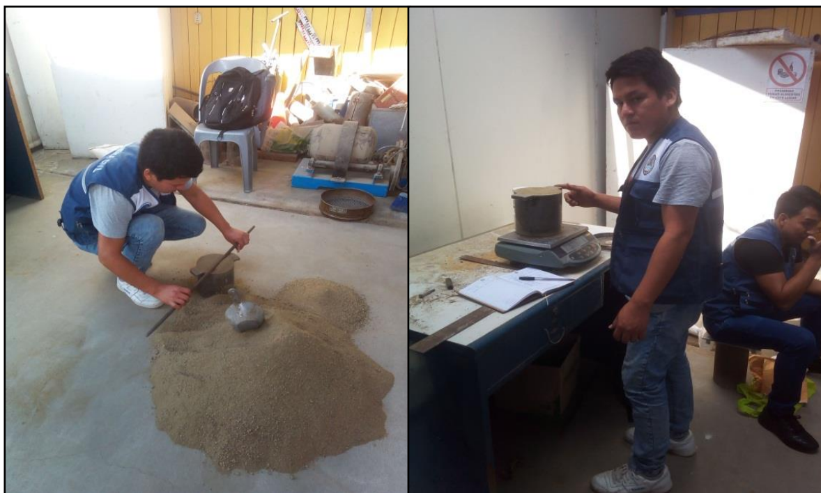
FOTO N°07, N° 08: Enrazado y pesado de la arena.
