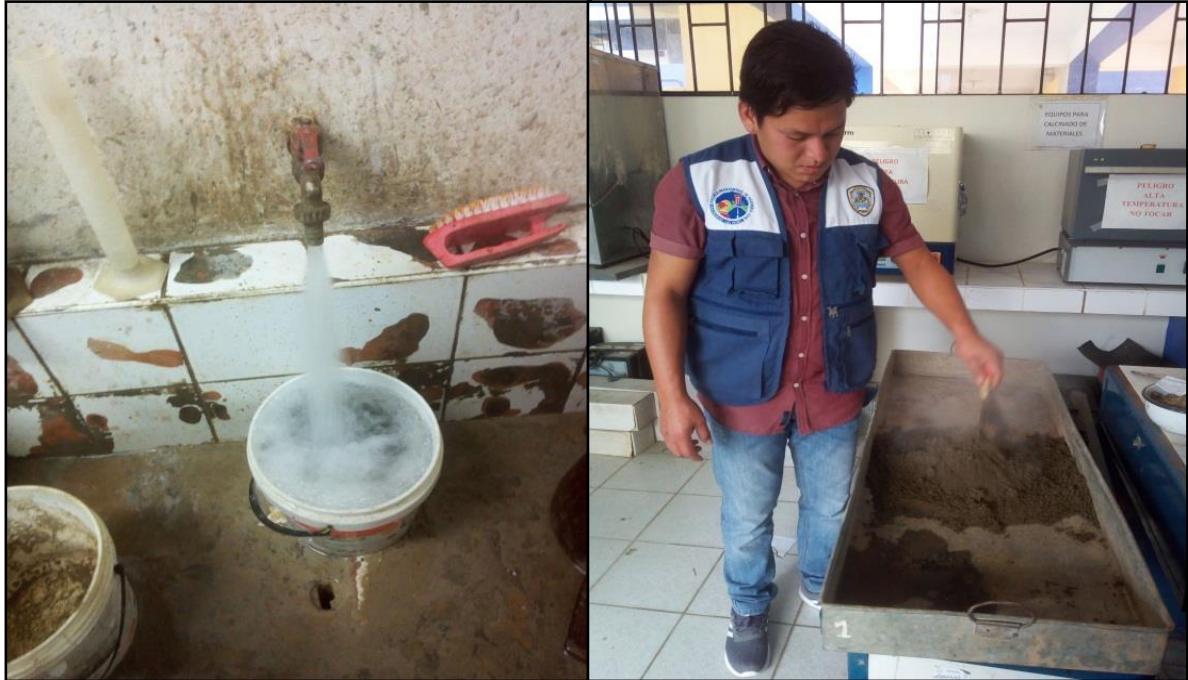
FOTO N°11, N°12: Lavado y secado de la arena.
