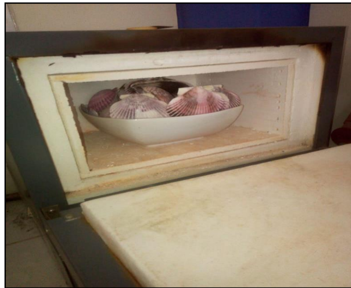
FOTO N°56: La Concha de abanico se calcino a una temperatura de 895°C durante 4 horas. Se hizo el calcinado en la Universidad San Pedro.
