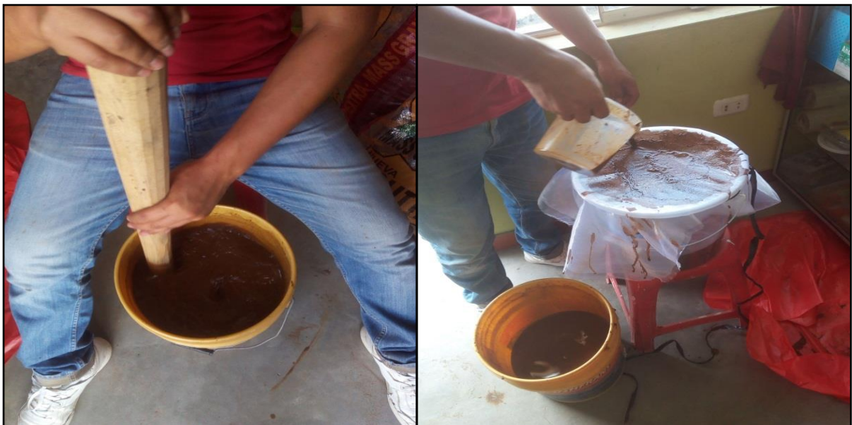
FOTO N°42, N°43: Ya completamente disuelta se coló la arcilla haciendo uso se la tela organza para retener la arena y piedras pequeñas.
