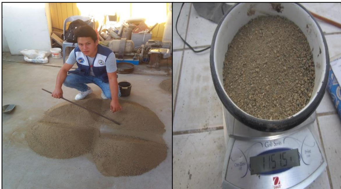
FOTO N°03, N°04: Cuarteado de los agregados y muestreo para contenido de humedad.
