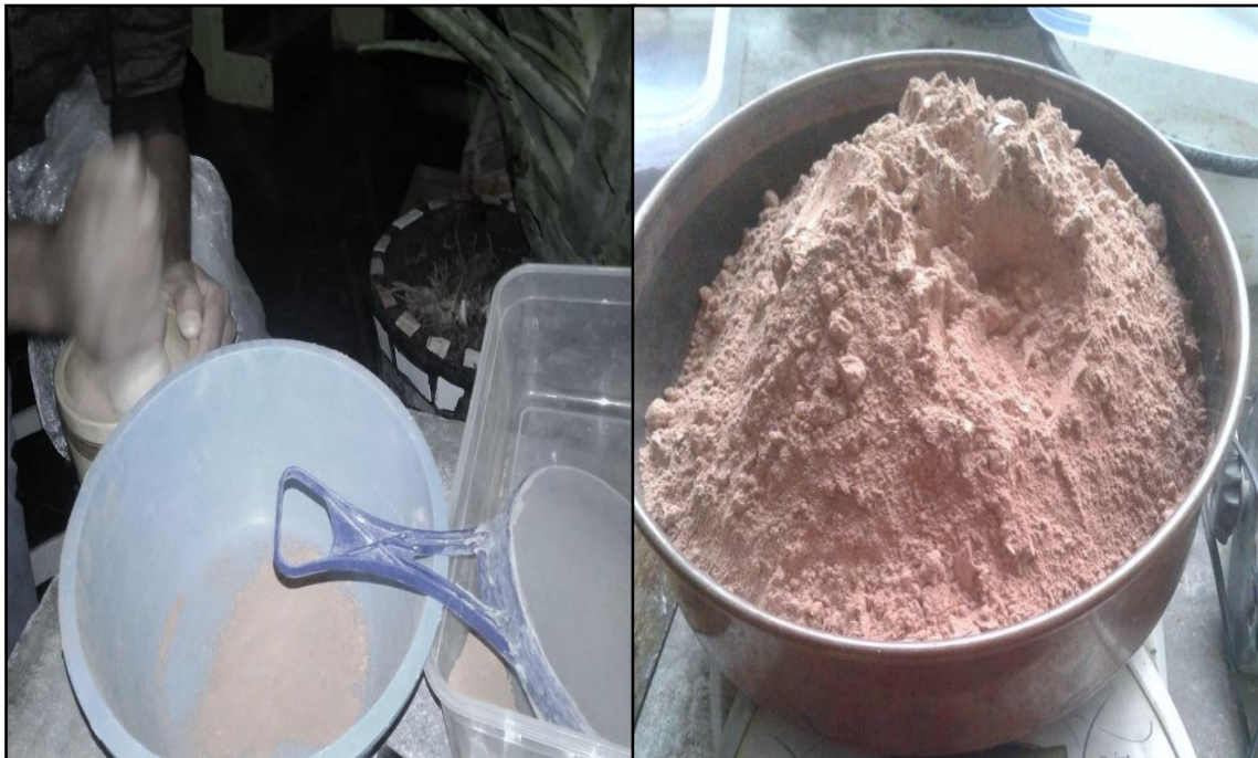
FOTO N°47: La arcilla se calcino tal como se obtuvo en el secado a una temperatura de 550°C durante 2hora. Se hizo el calcinado en la Universidad San Pedro.
