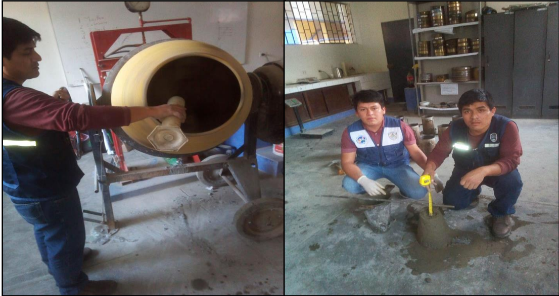
FOTO N°83, N°84: Proceso de elaboración de la mezcla de probetas experimentales con la prueba de consistencia o SLUMP.
