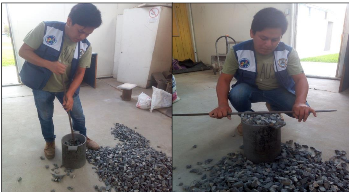
FOTO N°24, N°25: Varillado, enrazado y pesado de la piedra.
