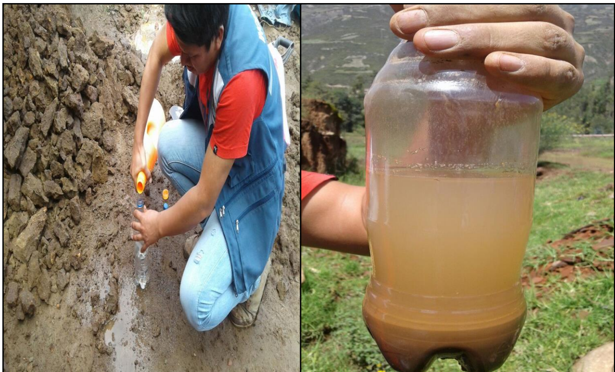
FOTO N°38, N°39: Prueba de la botella para verificar contenido de arcilla.
