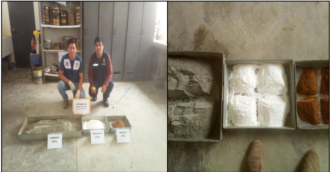
FOTO N°79, N°80: Se muestran los materiales en diferentes bandejas y se cuartea.
