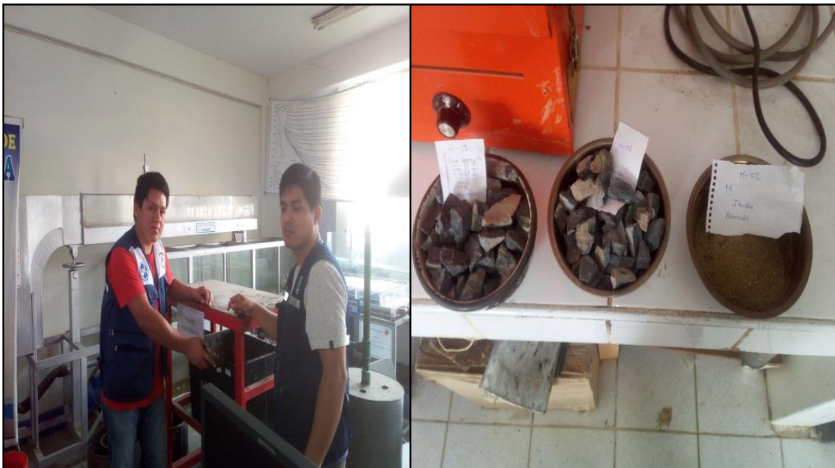
FOTO N°28, N°29: Obtención del peso sumergido de la piedra.
