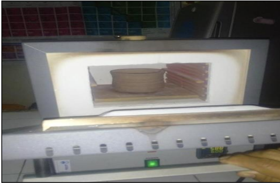
FOTO N°47: La arcilla se calcino tal como se obtuvo en el secado a una temperatura de 550°C durante 2hora. Se hizo el calcinado en la Universidad San Pedro.
