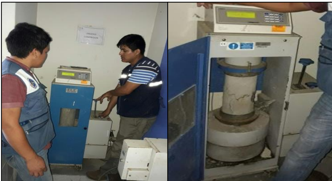
FOTO N°77, N°78: Aquí se aprecia cuando realizamos el ensayo a la compresión de los testigos en los diferentes días de curado.
