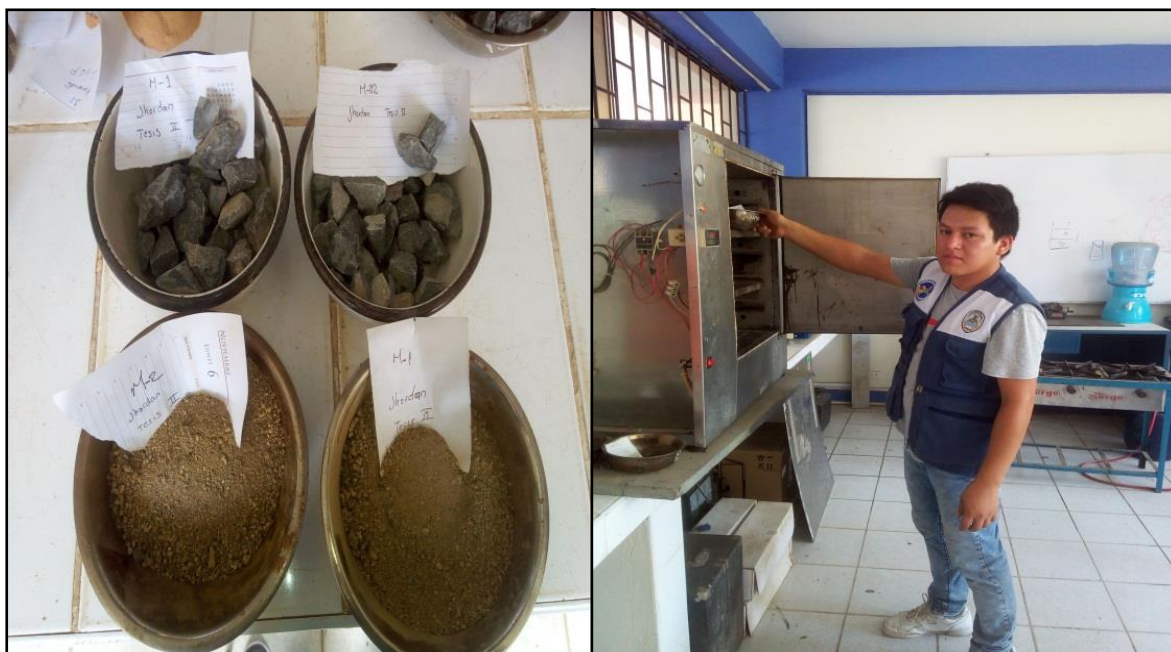
FOTO N°05, N°06: Pesado de la arena y llevado al horno para realizar el ensayo
