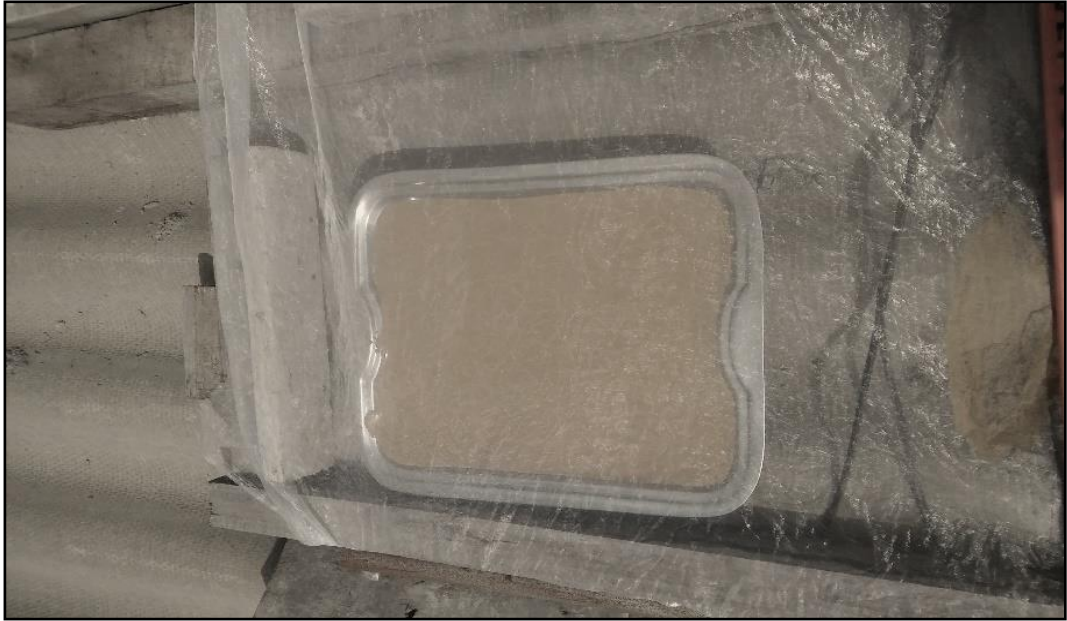
FOTO N°46: Para el secado de la arcilla se dejó secar a temperatura ambiente.
