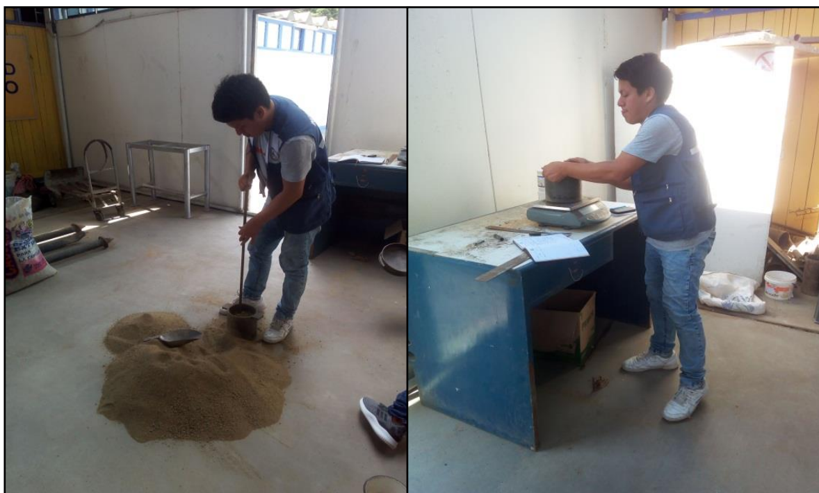
FOTO N°09, N°10: Varillado y pesado de la arena.
