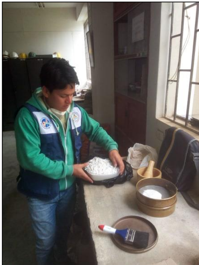
FOTO N°58: La Concha de abanico se molió en un mortero hasta obtener una finura de 200 micras. Esto se logró haciendo uso de una malla organza y un tamiz #200.
