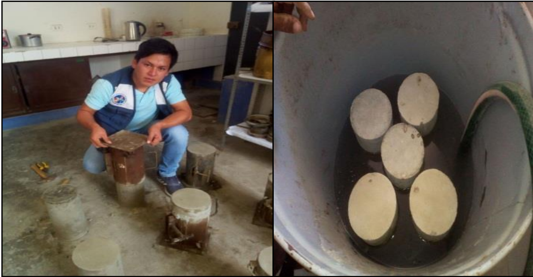
FOTO N°75, N°76: Se observa el desencofrado de probetas, posteriormente fueron sumergidas en agua para el curado correspondiente.
