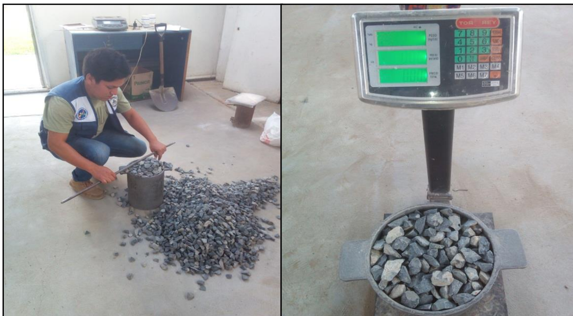
FOTO N°22, N°23: Enrazado y pesado de la piedra.
