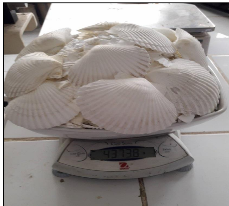
FOTO N°57: Pesando la concha de abanico al salir de la mufla para verificar la pérdida de masa.
