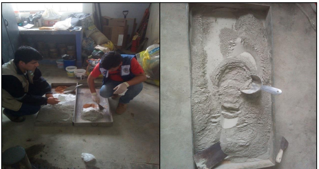
FOTO N°81, N°82: Se hace el mesclado tomando una cuarta parte de cada material, repetir hasta utilizar todo el material y se observe una muestra homogénea.
