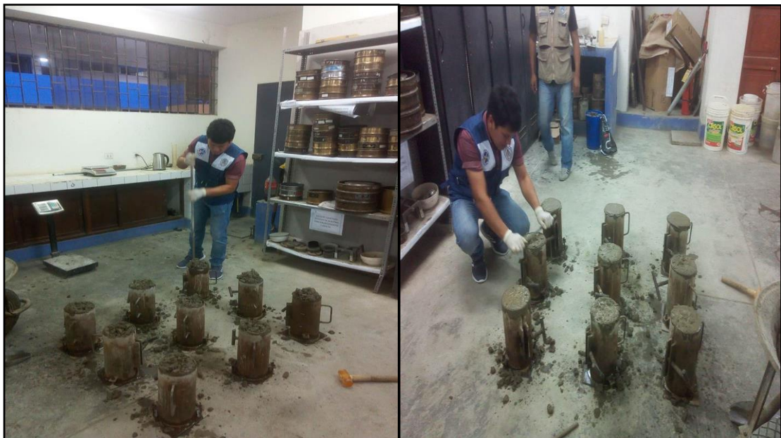
FOTO N°85, N°86: Vaciado de probetas experimentales, seguido del chuseado para compactación del concreto y finalmente enrazado.
