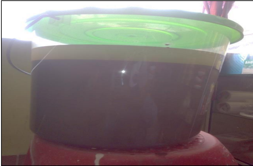
FOTO N°44: El material que pasó la tela organza se hecho en dos baldes transparentes de 15Lt juntamente con agua. Se dejó reposar 24 horas para facilitar que se separe los limos y la arcilla. Se retiró el agua después de las 24 horas haciendo uso de una manguera transparente y una jeringa.
