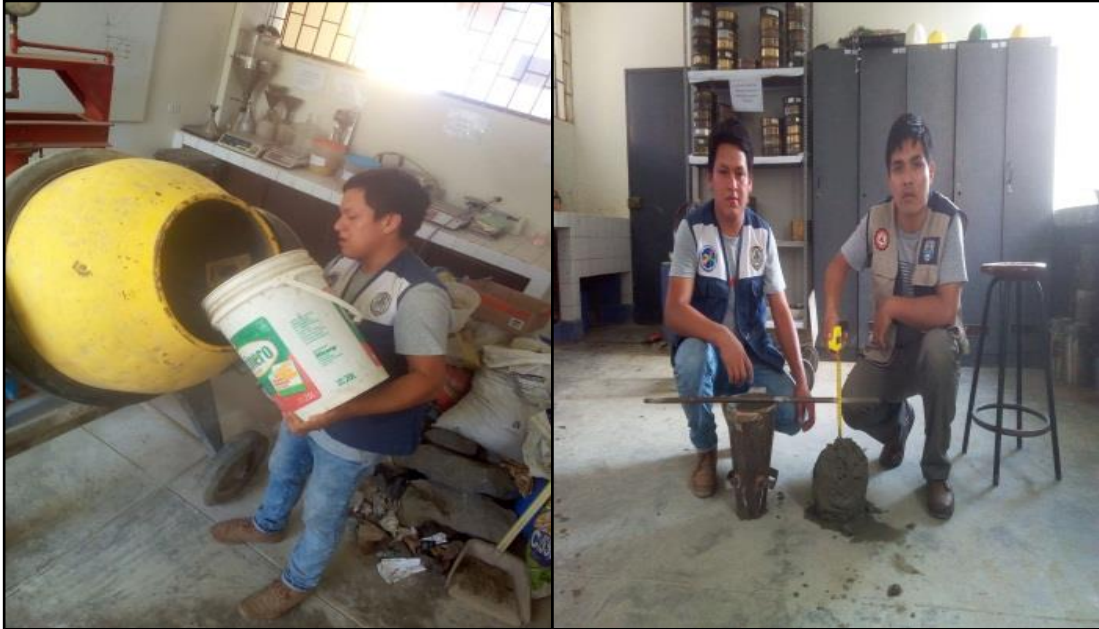
FOTO N°71, N°72: Elaboración de la mezcla y prueba de consistencia o prueba de SLUMP.
