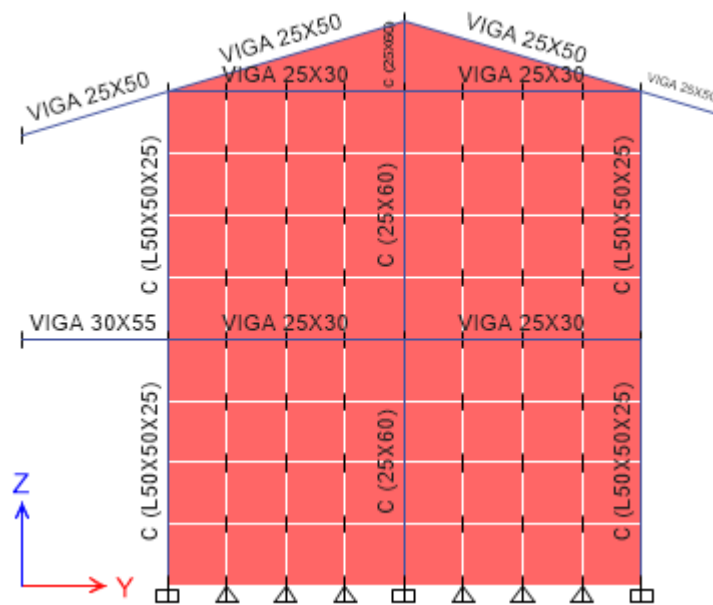
Figura 5. Elevación Lateral Típica (1er al 2do piso)
