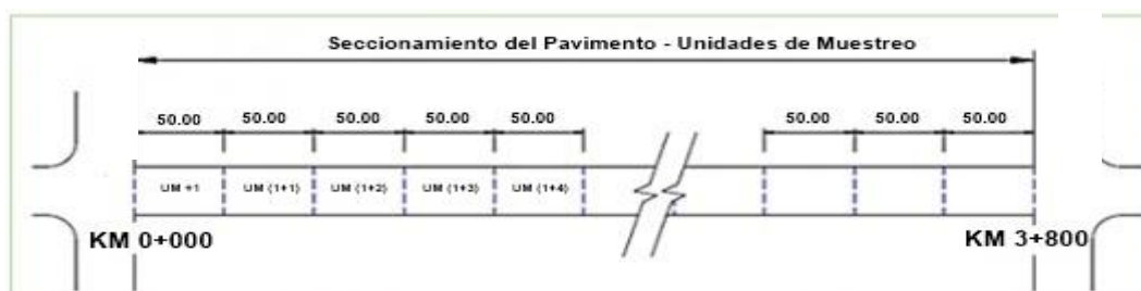
Figura 2 Seccionamiento del pavimento en unidades de muestra de la Av. Lomas
