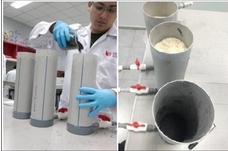
Figura 29: Instalación de sistema de biofiltros
