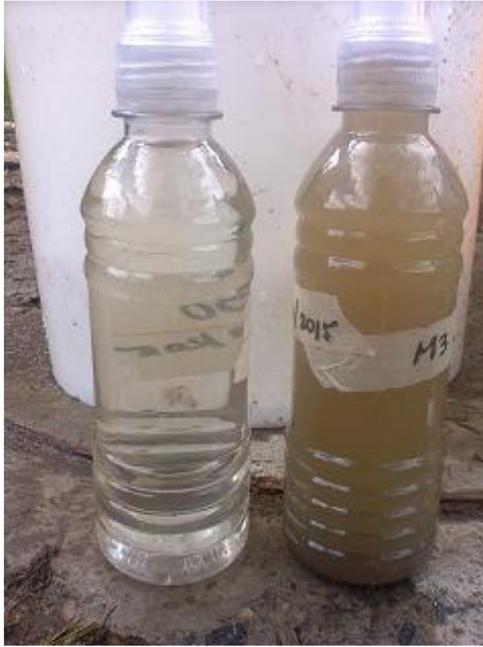
Fotografía 9. Muestra de agua residual (derecha) y muestra de agua residual tratada (izquierda)
