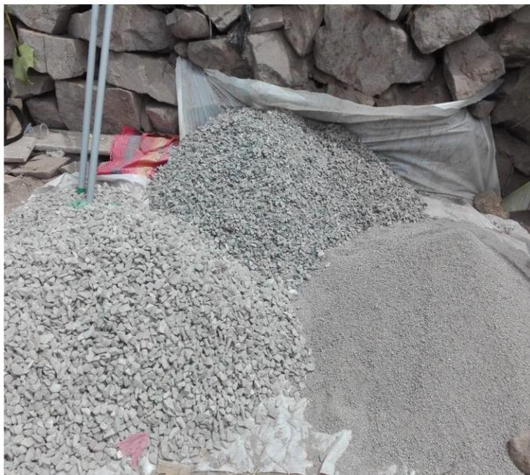
Fotografía 4. Material Granulométrico para el sistema de drenaje
