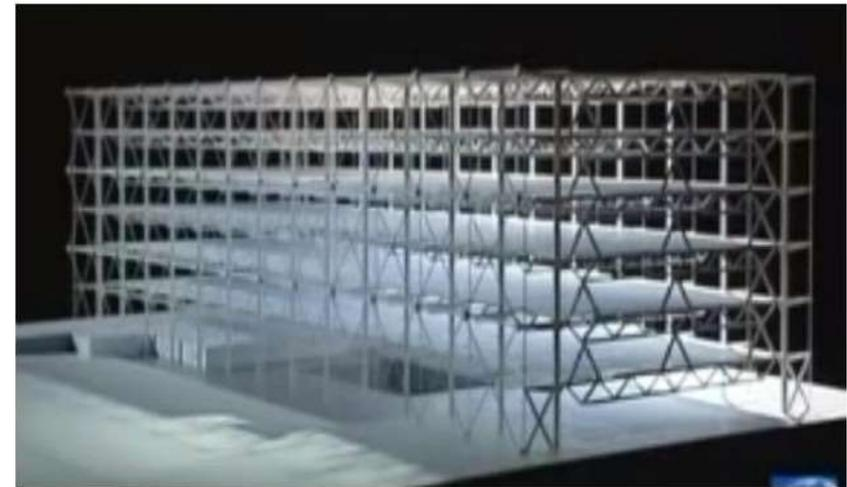
En las fachadas se añaden refuerzos metálicos en forma de V o X, fijados entre las vigas o a los extremos de las ínsulas, como protección contra el viento.
