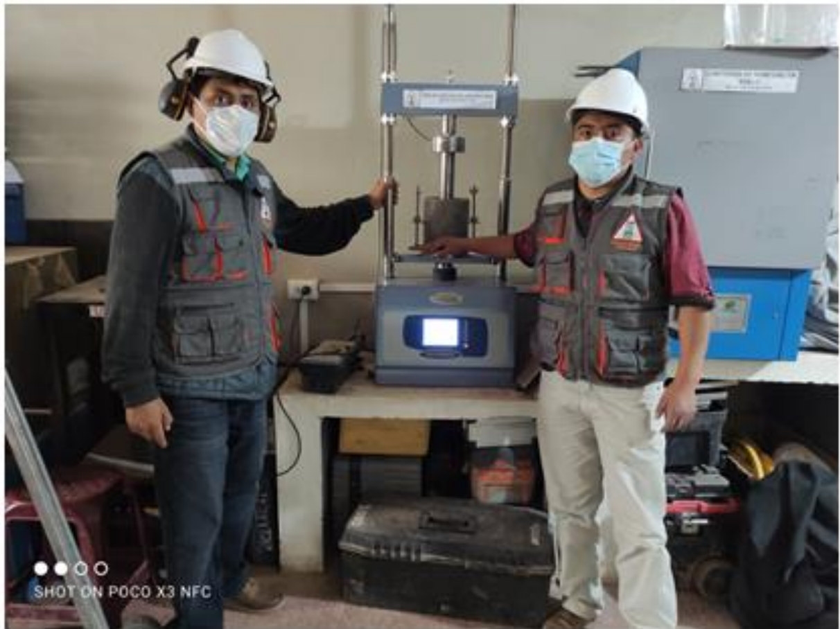
Foto N° 7: Ensayo de la resistencia al esfuerzo cortante CBR (California Bearing Ratio) de la muestra 02
