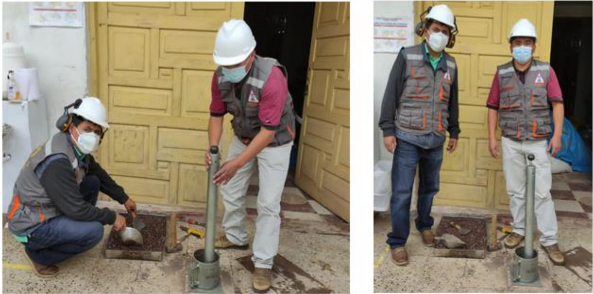
Foto N° 6: Ensayo de la resistencia al esfuerzo cortante CBR (California Bearing Ratio) de la muestra 01
