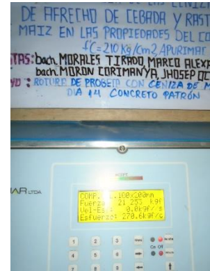
Figura 20: Rotura de Probeta del Concreto Patron 14 días.
