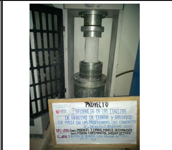
Figura 22: Rotura de Probeta con Ceniza de Rastrojo de Maíz 4% a los 7 días.
