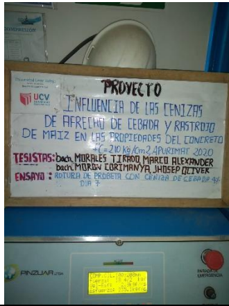
Figura 31: Rotura de Probeta con Ceniza de Afrecho de cebada 4% a los 7 días.
