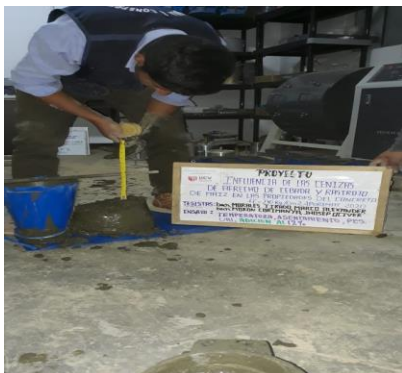
Figura 17: Ensayo de slump.
