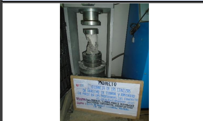
Figura 29: Rotura de Probeta con Ceniza de Rastrojo de Maíz 8% a los 28 días.
