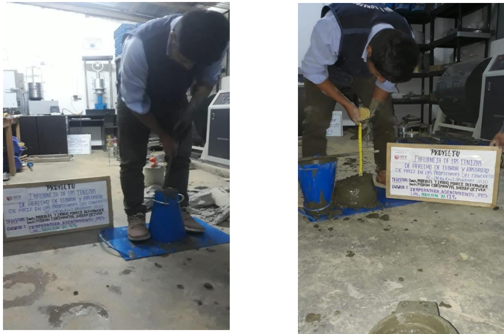
FIGURA 17. Ensayo de Asentamiento o Slump
