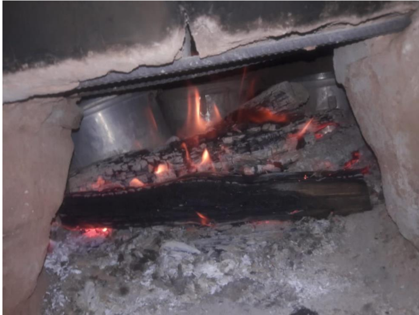
FIGURA 7. Incineración de ceniza de rastrojo de maíz en horno artesanal.
