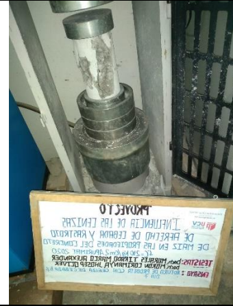
Figura 32: Rotura de Probeta con Ceniza de Afrecho de cebada 8% a los 7 días.
