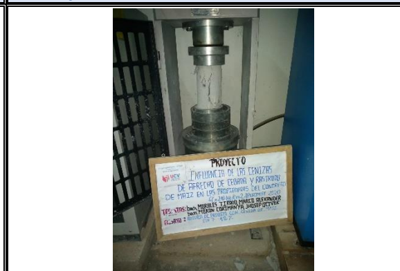
Figura 30: Rotura de Probeta con Ceniza de Rastrojo de Maíz 12% a los 28 días.
