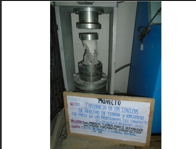
Figura 21: Rotura de Probeta del Concreto Patron 28 días.
