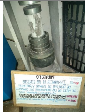
Figura 38: Rotura de Probeta con Ceniza de Afrecho de cebada 8% a los 28 días.
