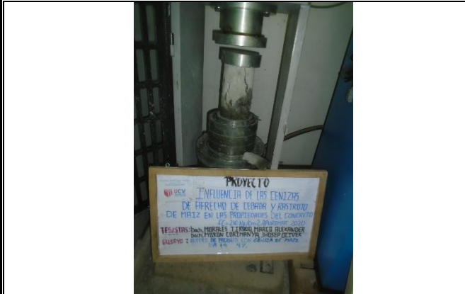
Figura 19: Rotura de Probeta del Concreto Patron 7 días.
