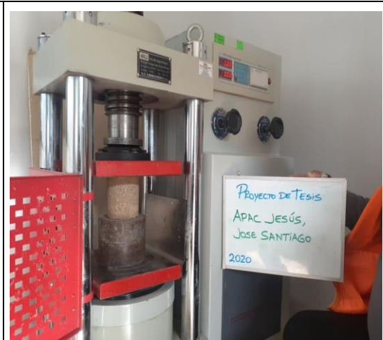
Ensayo de compresión en una probeta de suelo natural.
