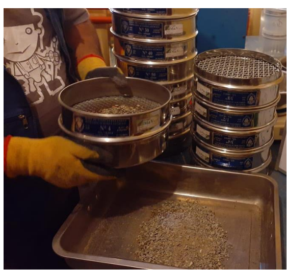
Ensayo de granulometria por tamizado del suelo natural.
