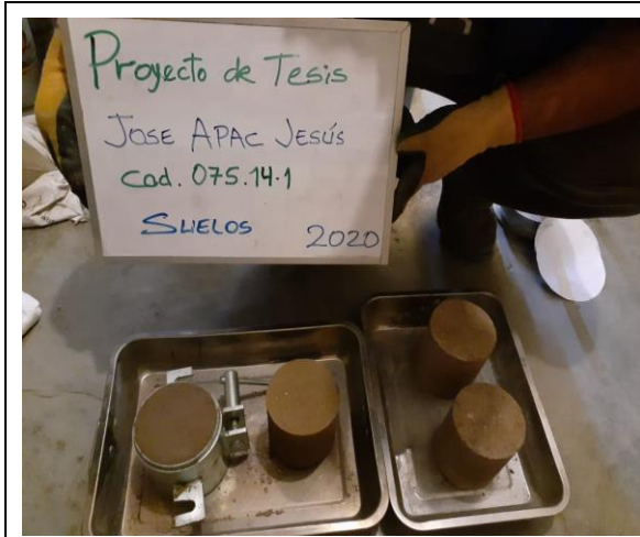
Compactación de suelo natural en probetas.
