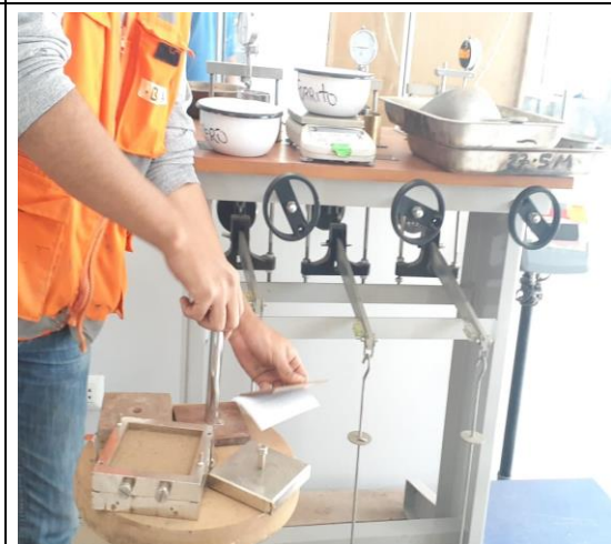
Colocación de espécimen en la caja de corte directo.
