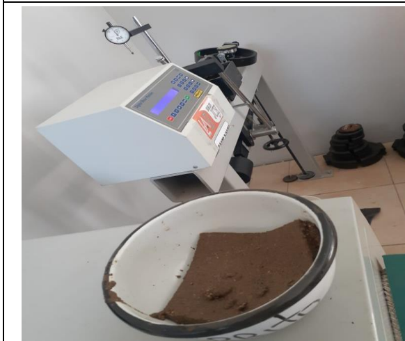
Colocación de espécimen en la caja de corte directo.
