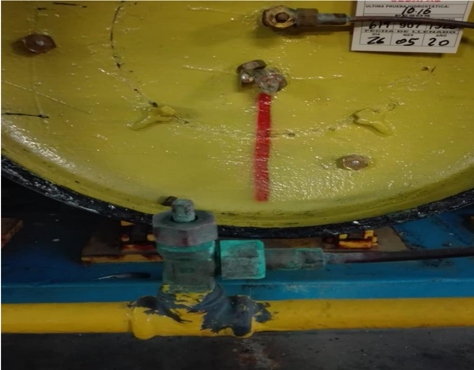
Válvula sulfatada producto de la exposición del cloro
