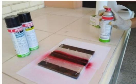
Figura 36. Spray de líquidos (Laboratorio Metalurgia UNT - 2018)
