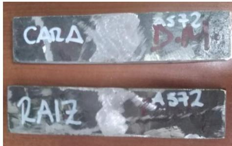
**Paso1.** La superficie convexa de las muestras para ensayo de doblez deberá ser inspeccionada visualmente para verificar discontinuidades superficiales.
