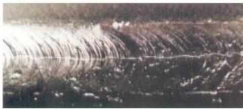
Figura 28. Fisura Longitudinal
