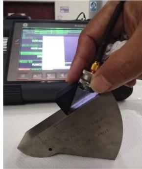
**Paso 2.** Medir espesor de pintura, galvanizado, calcular el espesor promedio y error cometido en la medida.
