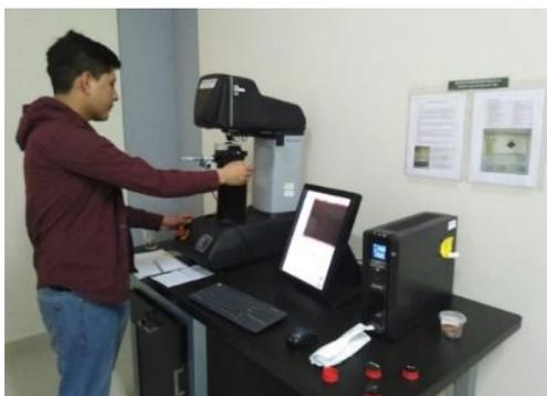
Figura 64. Micro durómetro digital – UNT Laboratorios de Metalurgia
