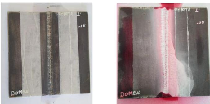
Figura 59. Ensayo de líquidos penetrantes acero Strenx 700
