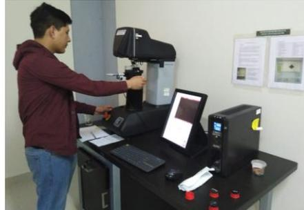
Figura 55. Equipo de Dureza Vickers – UNT Laboratorios de Metalurgia
