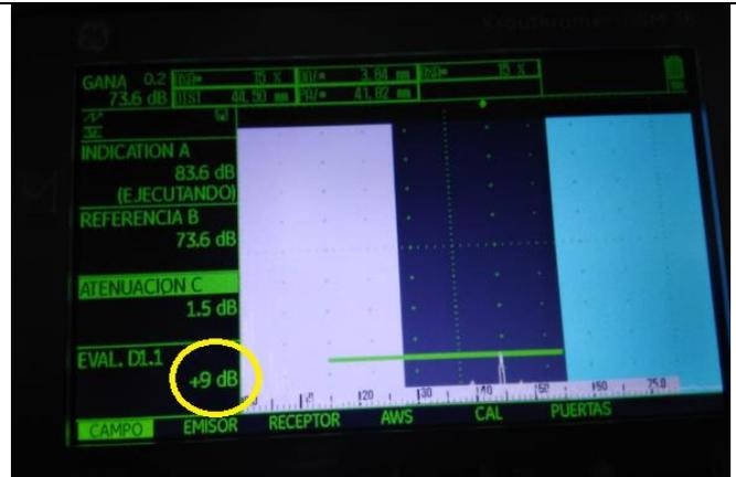
Se realizó el trazo según el cálculo hallado desde el centro de la junta 52.34mm. y 26.16mm. (Sd – Sd/2)
