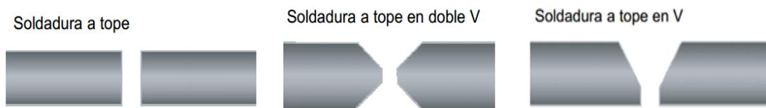
Figura 9. Tipos de preparación de bordes para aceros Strenx/Domex
