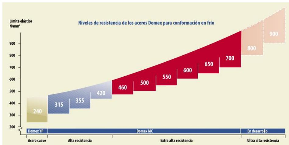
Figura 7. Niveles de resistencia de los aceros Strenx/Domex
