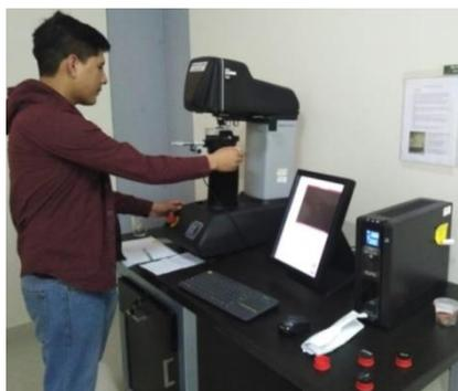
Figura 46. Ensayo de dureza Vickers Laboratorio Metalurgia – UNT 2018
