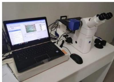
Figura 66. Microscopio metalográfico invertido – UNT Laboratorios de Metalurgia
