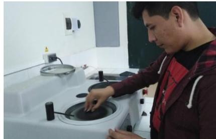
**Paso 4.** Una vez terminado de lijar la probeta, se empieza a pulir con alúmina sobre el paño de billar haciendo un movimiento radial.
