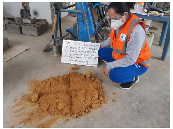
Fotografía 6 cuarteo del material para su clasificación
