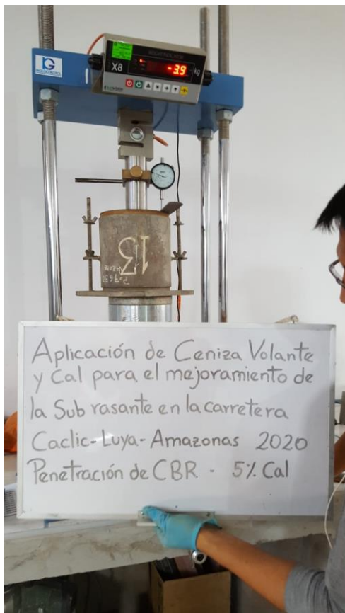
Fotografía 5 Ensayo de CBR terreno natural + 5% de cal
