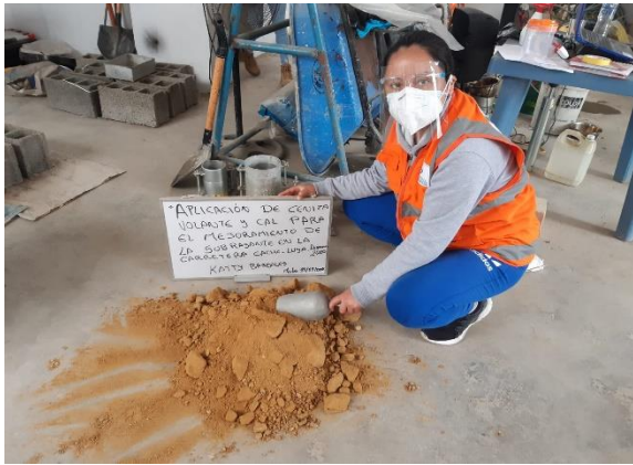
Fotografía 5 Material para ensayo de Granulometría
