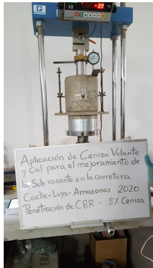
Fotografía 5 Ensayo de CBR terreno natural + 5% de ceniza volante
