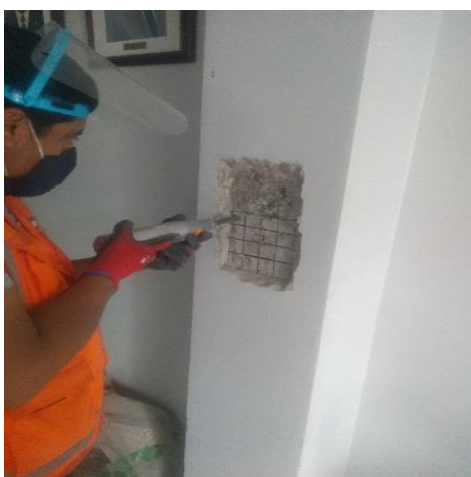
Figura 14. Ejecución de golpes en el esclerómetro y a la costa con la finalidad de medir el nivel de fuerza en una barra.
